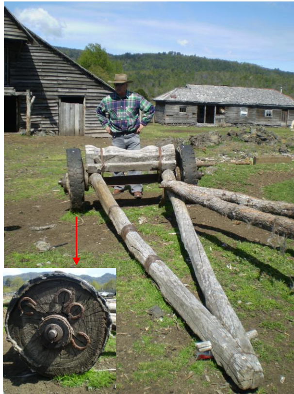
Figura 4. Carro utilizado para transportar las trozas desde el bosque al aserradero.
