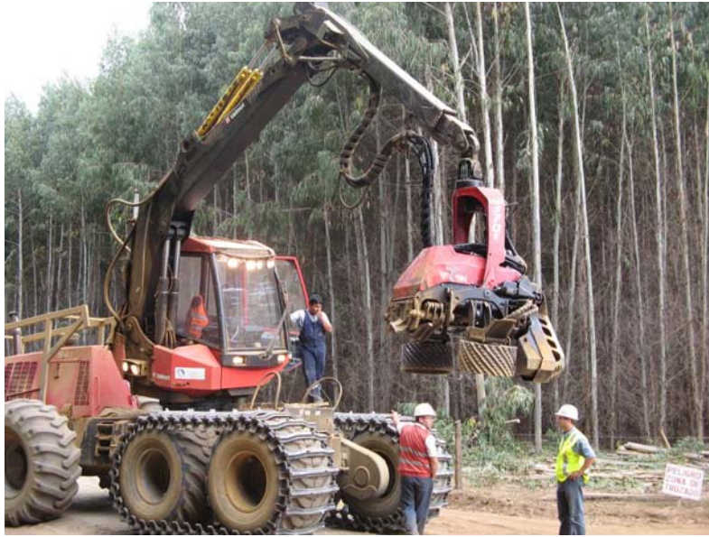
Figura 4. Harvester Valmet 941 con cabezal 370E.
