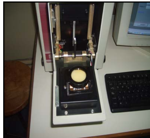
Muestra en la capsula e insertada al Equipo
