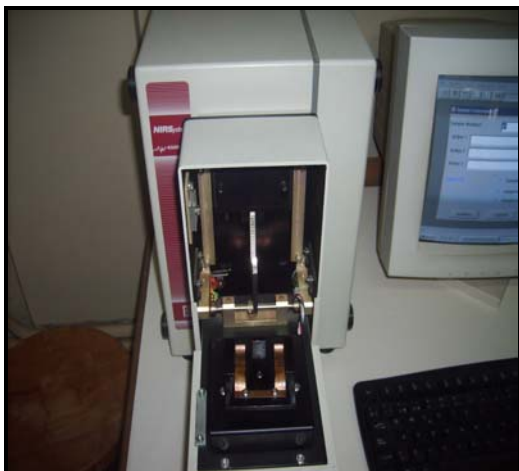
Soporte para insertar la muestra
