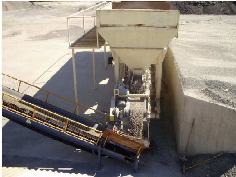
Fotografía 1.4: Cinta transportadora con pesa incluida.
