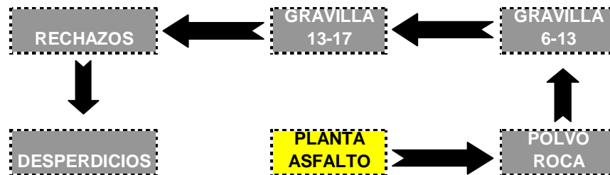
Figura 4.6: Ilustración de solución propuesta según algoritmo CORELAP
