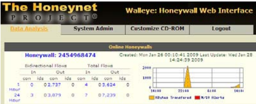
Figura N° 67 Respuesta del Honeywall al uso de Nmap
