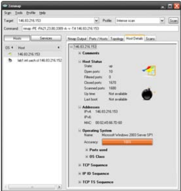
Figura N° 62 Sistema Operativo detectado por Zenmap
