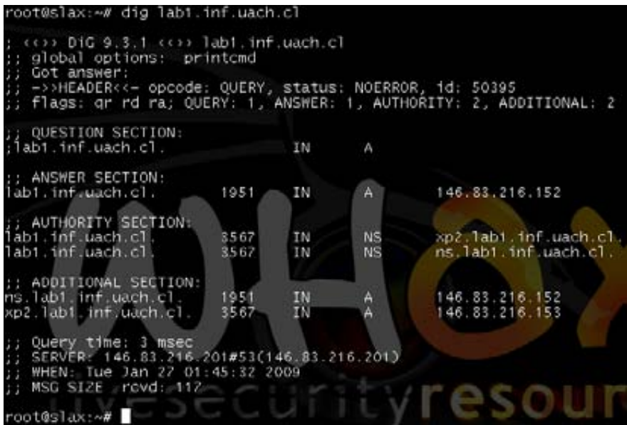
Figura N° 57 Utilización de dig para obtener información del dominio
