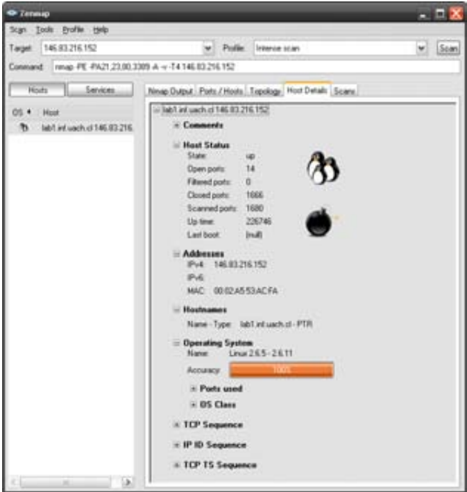
Figura N° 55 Sistema Operativo detectado por Zenmap
