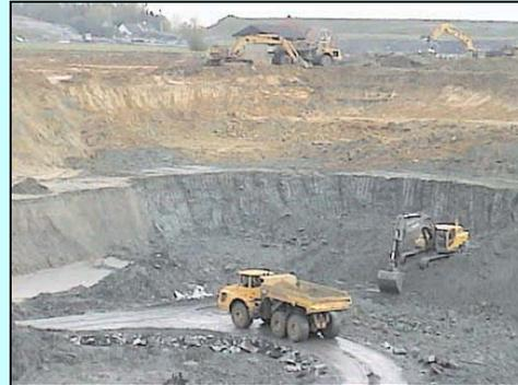
**Fig. 7.8:** Áreas de descubierta bien definidas. Trabajos ordenados de acuerdo con el proyecto de explotación. (Fuente: Asociación Nacional de Empresarios Fabricantes de Áridos, 2002)
