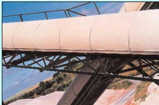
**Fig. 7.19:** Cintas con cubierta.
