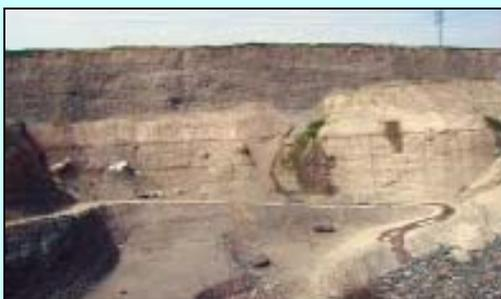
Fig. 1.13: Extracción desde pozo seco.
