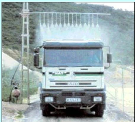
**Fig. 7.20:** Dispositivos de riego de cargas en camión. (Fuente: Asociación Nacional De
