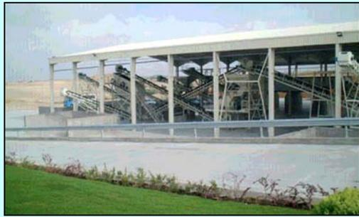
Fig. 6.4: Planta de tratamiento cubierta, con solera de hormigón y acopios encapsulados. (Fuente: Asociación Nacional De Empresarios Fabricantes De Áridos, 2005)
