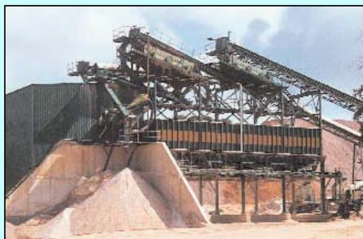
**Fig. 7.17:** Barreras laterales en acopio de finos.
