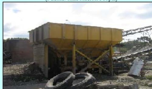
**Fig. 8.6:** Desde el buzón de carga es transportado hasta el seleccionador que lo separará en tamaños (Fuente: Elaboración Propia)
