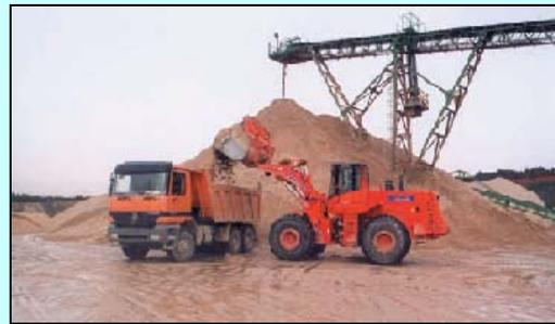
Fig. 1.4: extracción mecanizada de áridos molesto (Fuente: Asociación Nacional De Empresarios Fabricantes De Áridos, 2005)
