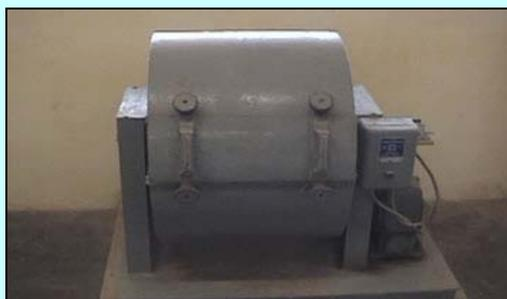
Fig. 4.3: Máquina de Los Ángeles, que permite medir la dureza del material, en el ensayo de Los Ángeles. (Fuente: BOUSO, 2002)
