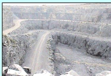
Fig. 7.13: Pistas amplias con rocas dispuestas a modo de muro como protecciones de seguridad (Fuente: Asociación Nacional De Empresarios Fabricantes De Áridos, 2002)
