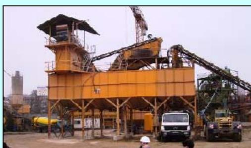
Fig. 3.15: Encapsulamiento en tolvas (Fuente: Áridos do Mendo, 2008)
