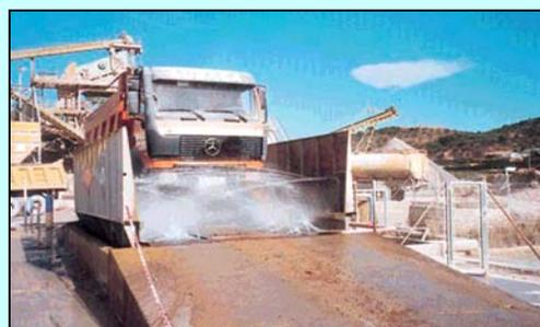
Fig. 6.17: Sistema de lavado de ruedas y parte baja del camión por agua a presión (Fuente: Asociación Nacional De Empresarios Fabricantes De Áridos, 2005)
