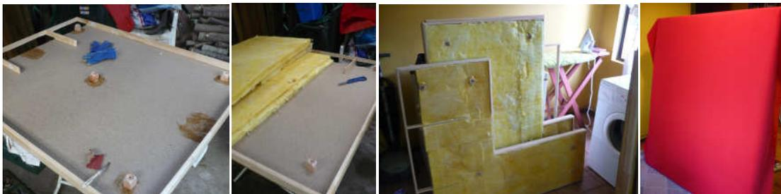
**Figura 38:** Montaje y revestimiento de lana en estructura. Este conjunto forma los absorbentes.
