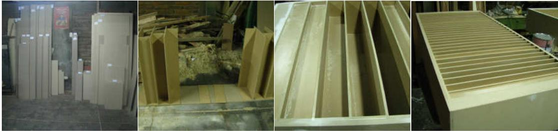
**Figura 36:** Material para la construcción de difusores.
