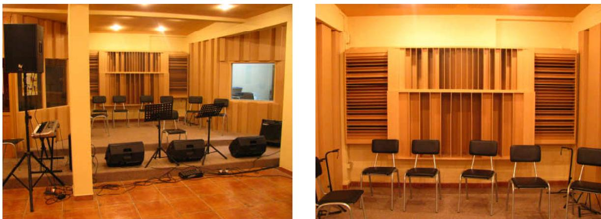
**Figura 41:** Difusores QRD y MLS instalados al fondo y costados del escenario.
