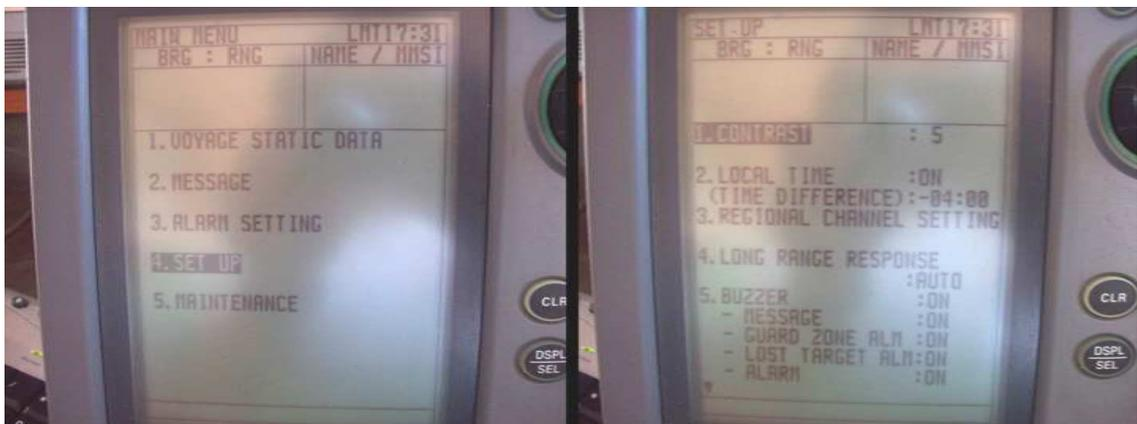
Imagen 123. La imagen de la izquierda muestra el menú principal del AIS y la selección de la opción SET UP (Configuraciones). La imagen de la derecha muestra el submenú SET UP con las opciones que ofrece; Contraste de la Pantalla, Hora Local, Respuesta a Largo Alcance, Avisos Sonoros, entre otros.
