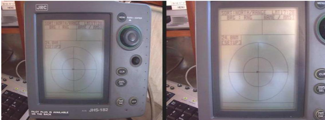
Figura 117. Pantalla Principal del AIS, muestra los datos y estado del entorno en presencia de otras embarcaciones con equipos AIS o ayudas a la navegación que puedan poseerla. Nótese que los controles son diferentes a los que he considerado, debido principalmente a que las marcas existentes en el mercado adaptan las características ergonómicas a su mejor comodidad. Aquí el Mouse (TrackBall) es reemplazado por una rueda giratoria y limita su panel a los botones necesarios para su manejo.
