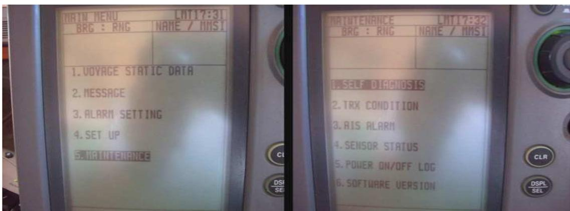
Figura 124. La imagen de la izquierda muestra el menú principal del AIS y la selección de la opción MAINTENANCE (Mantenimiento). La imagen de la derecha muestra el submenú MAINTENANCE ya ingresado y muestra las diversas opciones que posee; Auto Diagnóstico, Condición TRX, Alarma AIS, Estatus de Sensores, Versión del Software, entre otros.
