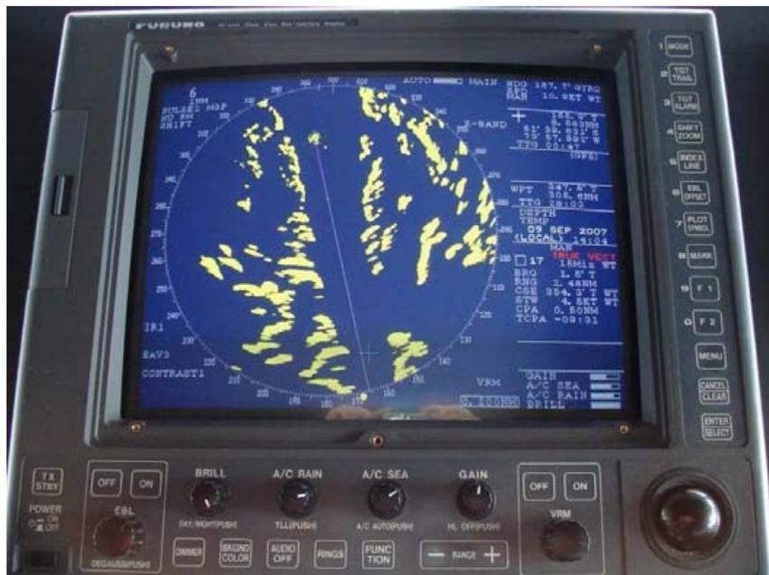
Figura 78. Se observa el panel del radar con los controles principales bajo la pantalla; una rueda para mover el cursor y sus botones de manejo. Además se pueden ver los controles para acceder a los menús y configuraciones del equipo. Si bien se observa una disposición diferente a la que he mencionado anteriormente, se debe, a que cada marca existente en el mercado busca las mejores disposiciones ergonómicas para manejar el equipo.
