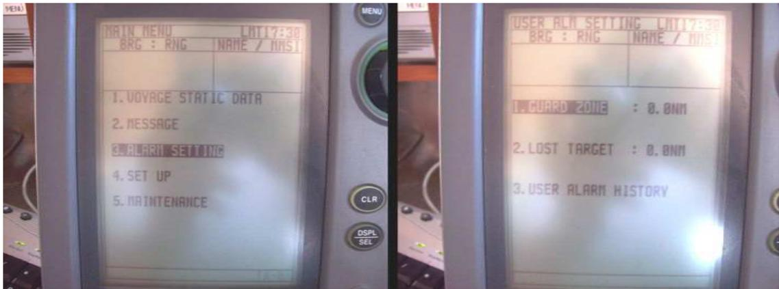
Figura 122. La imagen de la izquierda muestra el menú principal del AIS y la selección de la opción ALARM SETTING (Configuraciones de la Alarma). La imagen de la derecha muestra el submenú ALARM SETTING con las opciones que presenta; Zona de Guardia, Blancos Perdidos, Historial de Alarma.
