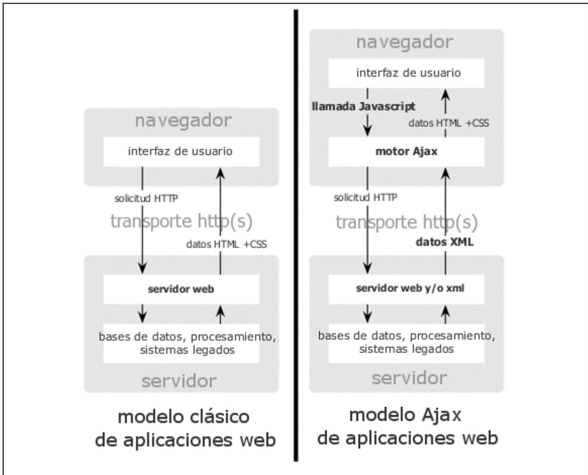
FIGURA 8. Modelo tradicional comparado con el modelo AJAX.
