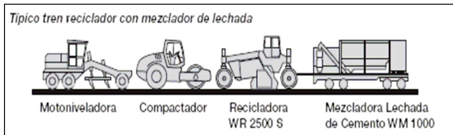
**Figura N°7, Tren de reciclado con lechada.**
