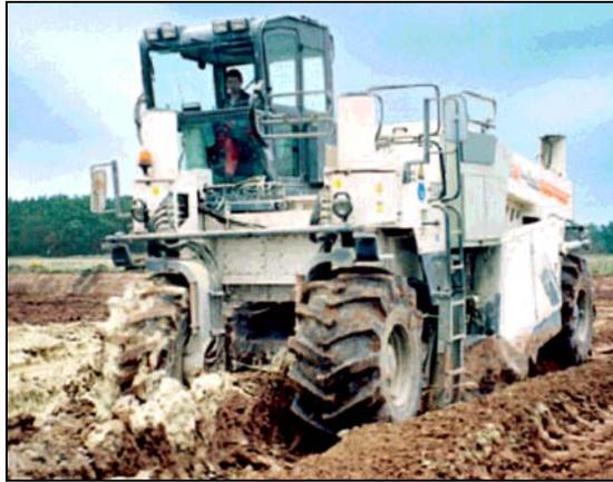
*Figura A1.3, Tracción recicladora.*
