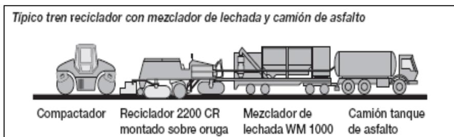
**Figura N°8, Tren de reciclado con asfalto.**
