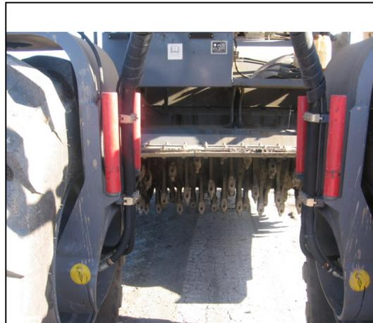
*Figura N°17, Rotor fresador.*
