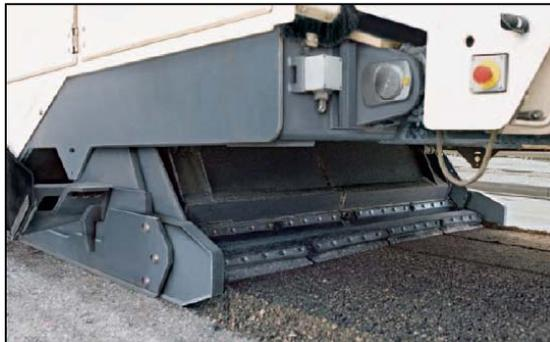
**Figura A1.2, Sistema de nivelación recicladora.**
