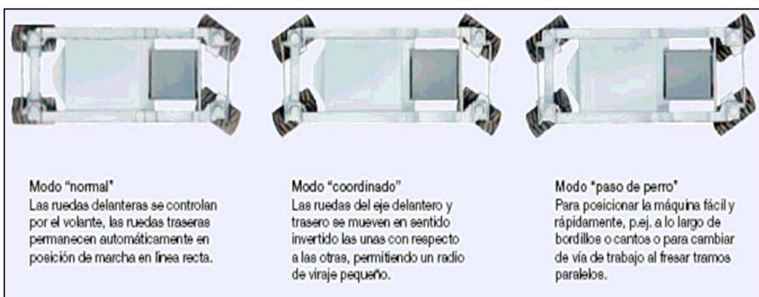
**Figura A1.4, Sistema de dirección.**
