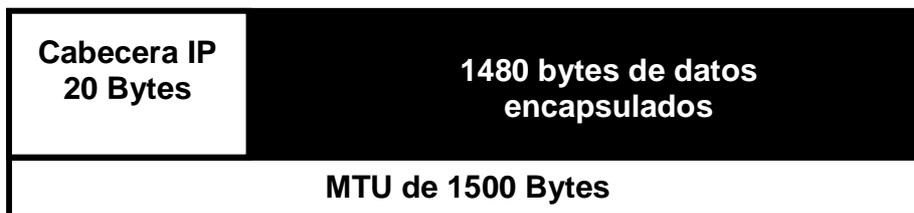
Figura N° 2.21 – Configuración Datagrama IP no fragmentado con MTU de 1500 Bytes
