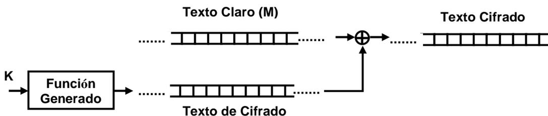
Figura N° 4.8 – Esquema de Cifrado y Descifrado en Flujo
