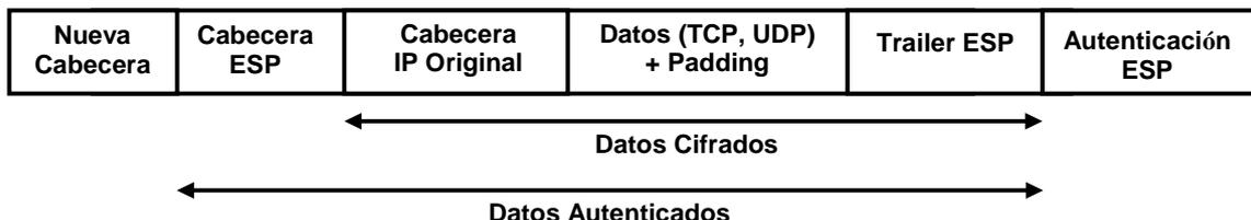
Figura N° 4.18 – Modo Túnel ESP
