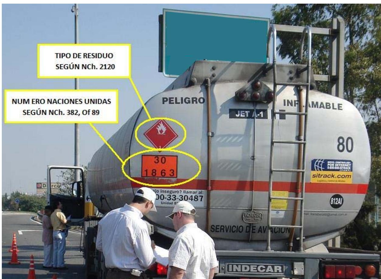
Fig. 18. Identificación de residuos según las normas NCh. 382. Of. 89 y NCh. 2120
