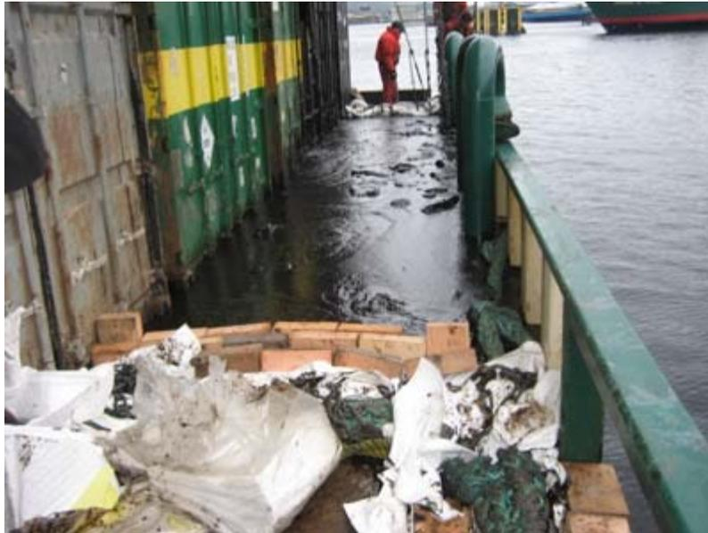
**Fig. 8. Derrame de H.F.O. en la Cubierta de una Nave**
