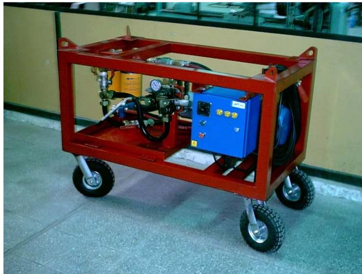
**Fig. 7. Máquina para hacer limpieza por flushing.**
