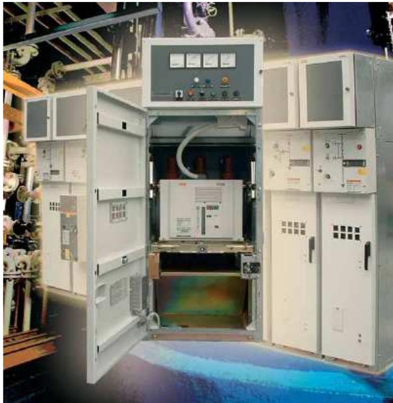
Esta celda cumple con las normas eléctricas estandarizadas, tales como IEC 62271-200, IEN 62271-200, certificación para servicio continuado LSC2A. Sus rangos de temperatura fluctúan entre  $-5\text{ }^{\circ}\text{C}$  y  $40\text{ }^{\circ}\text{C}$ , humedad relativa del aire 95 % sin condensación y su postura de trabajo en superficies menores a 1000 M.S.N.M.
