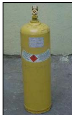
Figura N° 3.35 Tanque de Acetileno
