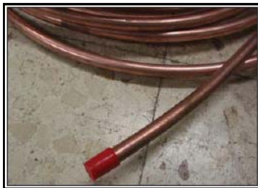
Figura N° 3.4 Sellado de los tubos
