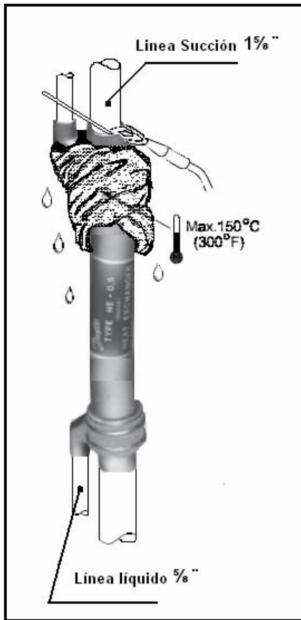
Figura N° 3.70 Soldadura y conexión Figura N° 3.71 Intercambiador de calor instalado
