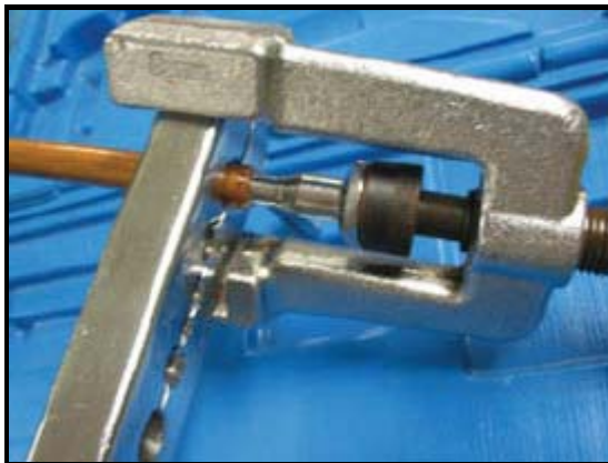
Figura N° 3.87 Colocación del tubo
