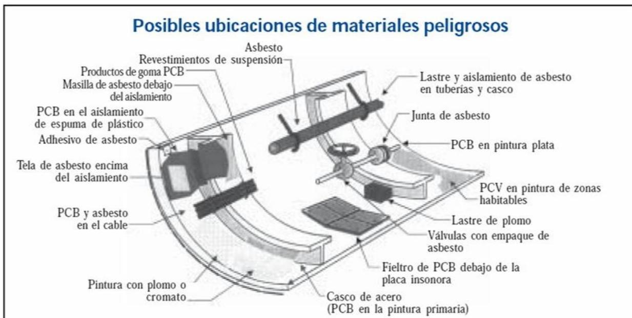
figura 12. Ubicación de materiales peligrosos en la estructura de un buque.
