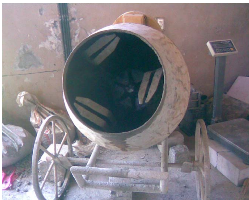
Figura 4.12. FOTO - Betonera para confeccionar la mezcla de los componentes dosificados.
