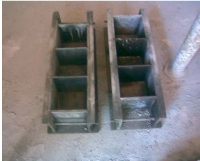
Figura 3.2. Foto - Moldes cúbicos de 15cm de arista.
