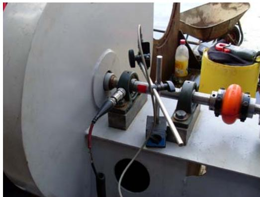
**Figura 9.13:** Medición de desbalance de ventilador centrífugo.
