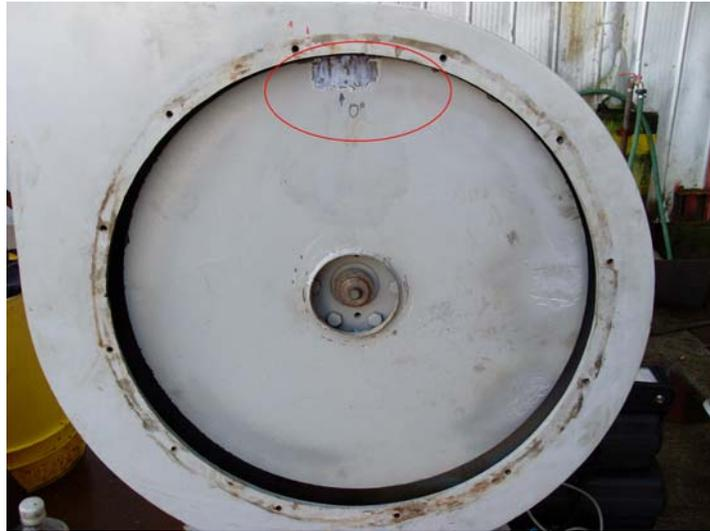
**Figura 9.16:** Localización del peso prueba.
