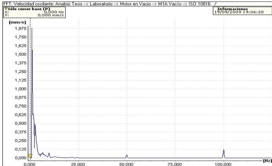
**Figura 9.4:** Espectro axial en velocidad selectiva de motor eléctrico.
