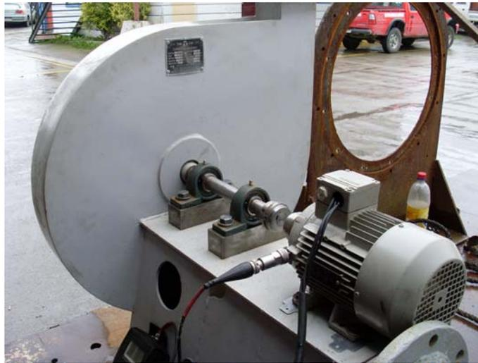
**Figura 9.1:** Medición de vibración motor eléctrico en vacío.
