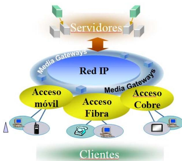
**Figura 3.** El papel del protocolo IP en las Redes de Próxima Generación.<sup>8</sup>
