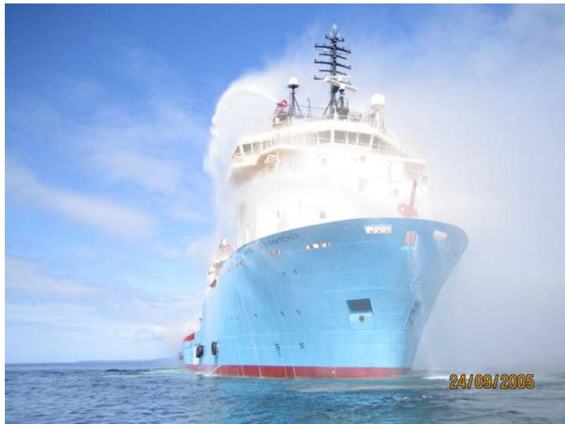
Figura 4.16: Funcionamiento del sistema water spray.
