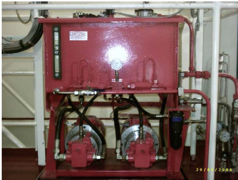
Figura 4.14: Power pack hidráulico.
