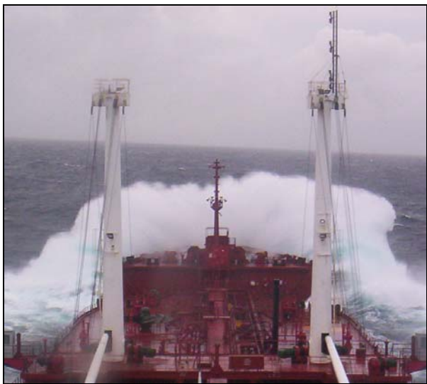
Fig. 18 En la fotografía, las formas de la proa permiten “abrir” el agua expulsándola en un ángulo de aproximadamente 45°. Dicha acción produce un empuje que evita en parte la inmersión de la proa en los cabeceos.
