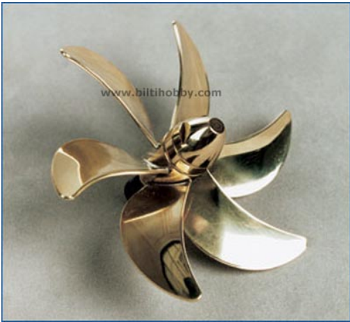
Fig. 31 De una gama bastante amplia en la oferta de propulsores para modelos a escala, la hélice de aleación de bronce de la figura 33 es una de las mejores aproximaciones a la original. Con sus seis palas, un diámetro de 6,5 cm, un paso dextrógiro de 6,66 cm y una rosca hembra M4 para acoplamiento al árbol.
