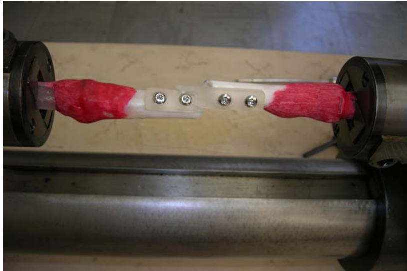
Figura 2. Placa de Compresión Dinámica sometida a fuerza de rotación, con ruptura en el 2º orificio.
