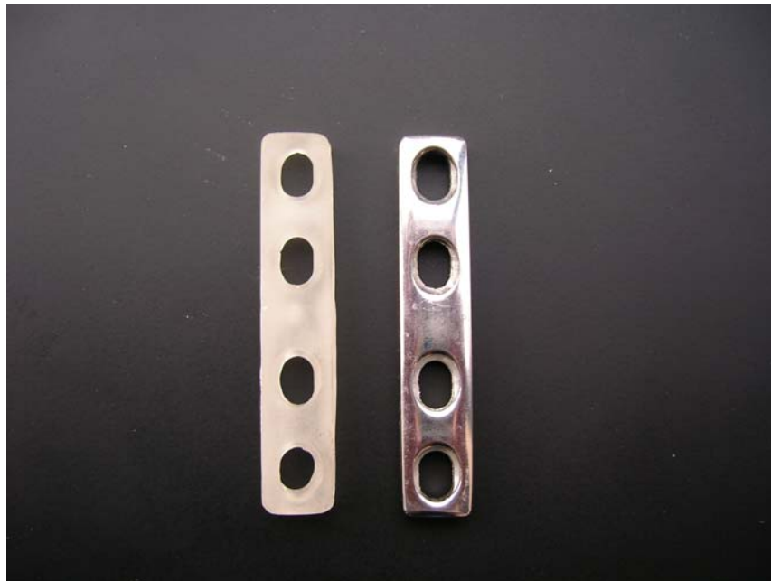
Figura 1. Placas de Compresión Dinámica de Polimetilmetacrilato (lado izquierdo) y de acero quirúrgico LN 344 de 4 orificios (lado derecho).
