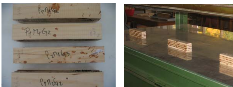
Figura 6. Probeta formada por 5 tablillas, nomenclatura y posterior prensado.
