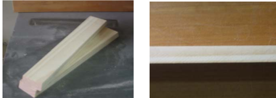
Figura 2. Tablillas de 300*60*23 (mm) antes de maquinado.
