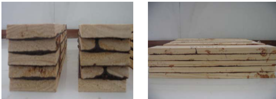
Figura 5. Probeta de tablillas encoladas por ambas caras.
