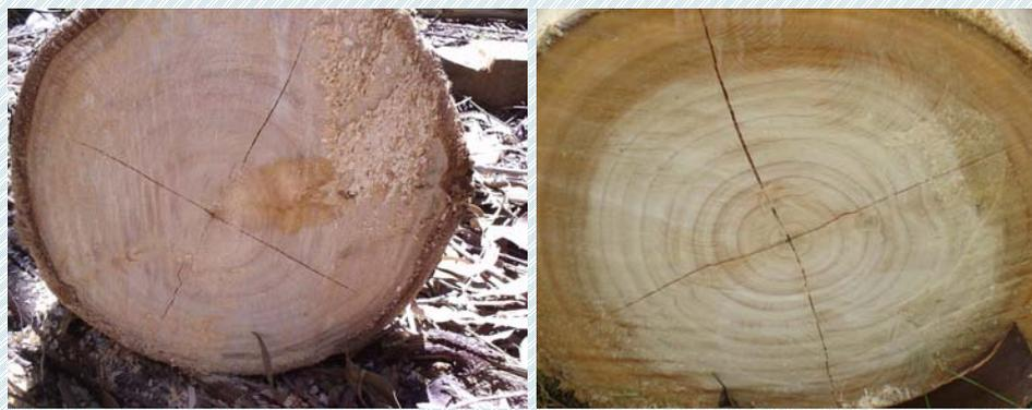
Figura 4. Izquierda, grietas en híbrido *E. nitens-globulus*; derecha, grietas en *E. nitens*
