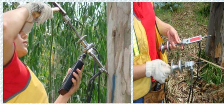
Figura 8. Medición de la Velocidad de sonido en árboles en pie
