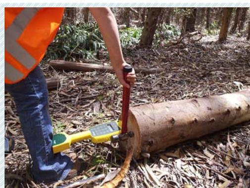
Figura 9: Medición de velocidad en trozas *Hitman*
