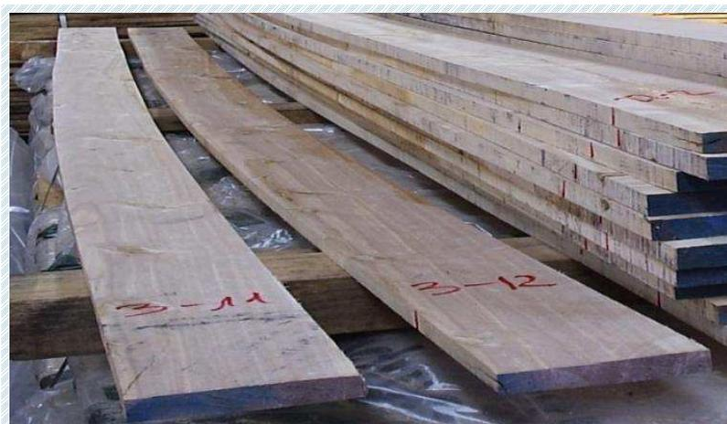
Figura 6. Arqueadura en tablas aserradas producidas por la liberación de tensiones de crecimiento (Fuente: Mutizabal, 2008)
