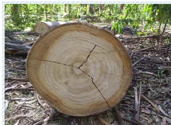
Figura 5. Grietas irregulares en dirección y magnitud en *E. nitens*
