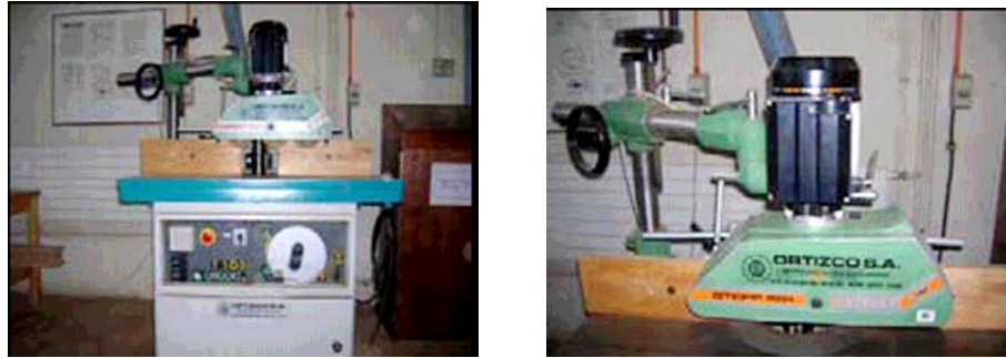
Figura 4 Máquina tupí y carro de avance
