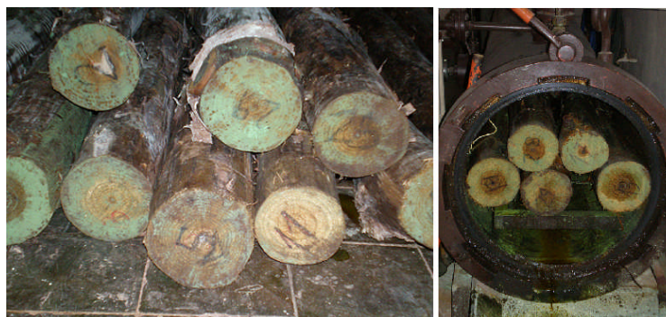
Figura 7. Rolletes en proceso de impregnación.
