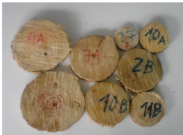
Figura 6. Rodelas para obtención de densidad básica y contenido de humedad.
