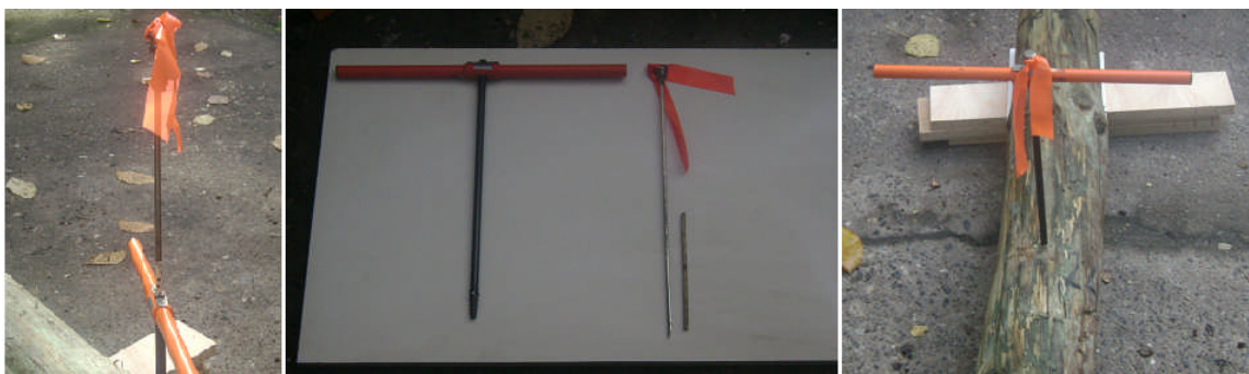
Figura 11 Taladro de incremento y la extracción de muestras para Penetración.
