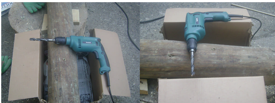
Figura 9 Ubicación de extracción del aserrín para calcinación.
