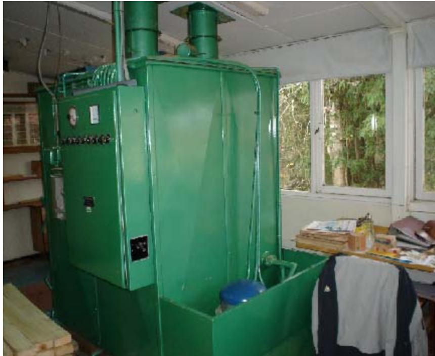
Figura N° 1 Cámara de secado
