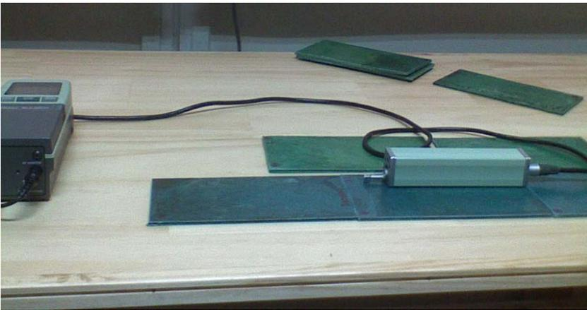
Figura 4: Tester de rugosidad por contacto tipo stylus modelo Mitutoyo SJ-210
