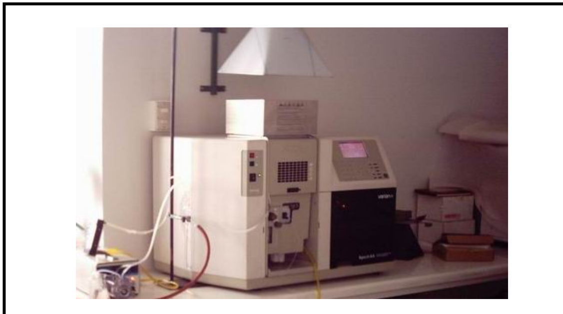
FIGURA 3 Equipo Espectrofotómetro de Absorción Atómica. Marca Varian, modelo SPECTRA A-55.
