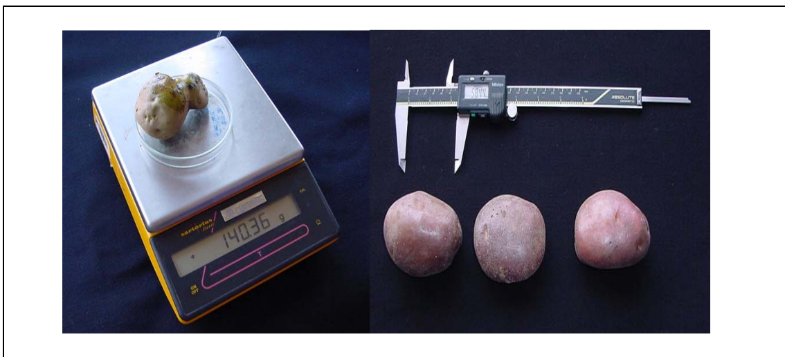
FIGURA 4 Balanza y pie de metro digital ocupados para la medición de peso y diámetros ecuatorial y polar respectivamente.
