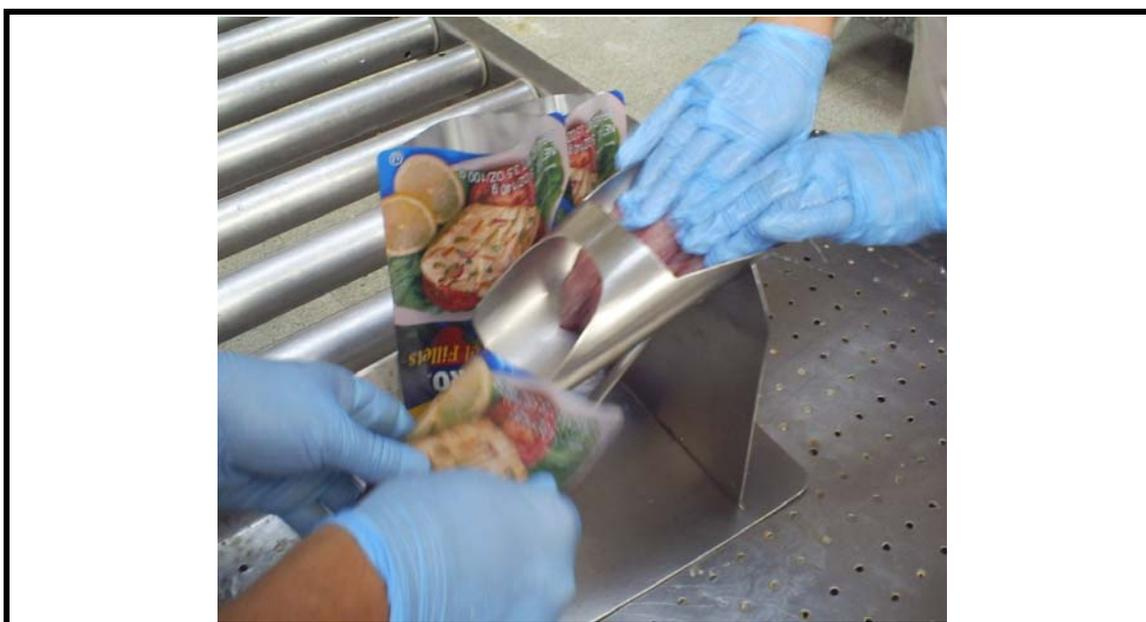
**FIGURA 2. Sistema de llenado de filetes con boquilla dosificadora metálica.**
