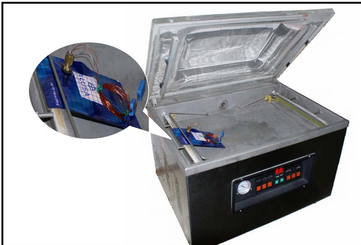
**FIGURA 34. Selladora al vacío Plaspak Modelo KVP-650T.**
