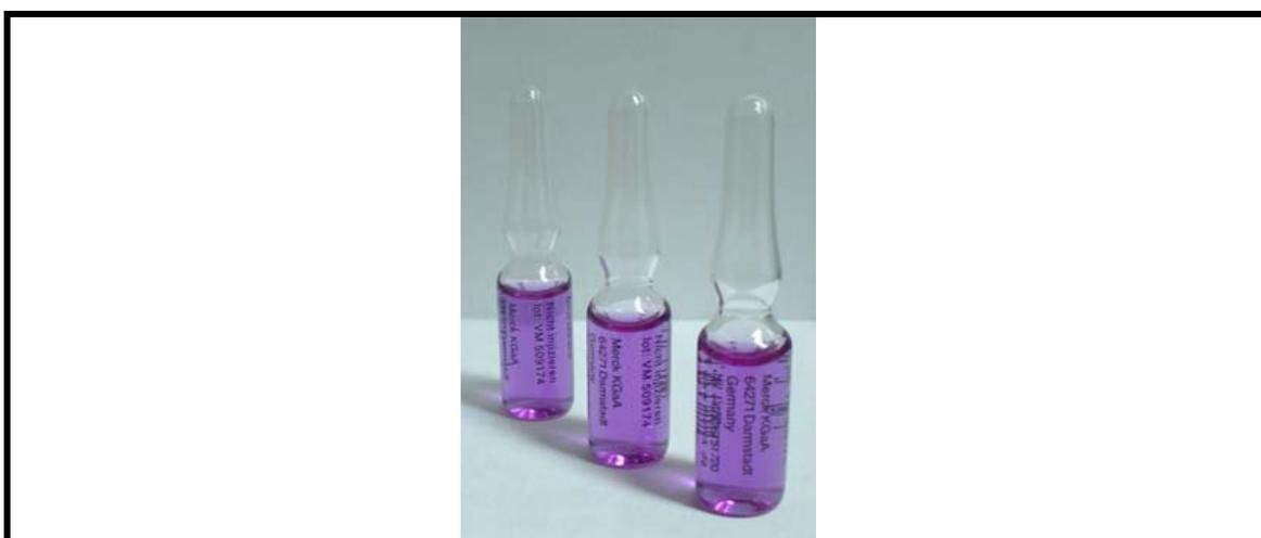
**FIGURA 19. Bioindicador Sterikon® plus marca MERCK.**
