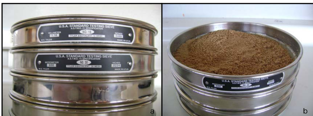
FIGURA 7 Tamices A.S.T.M E-11 (a) Harina de linaza una vez finalizada la molienda (b)
