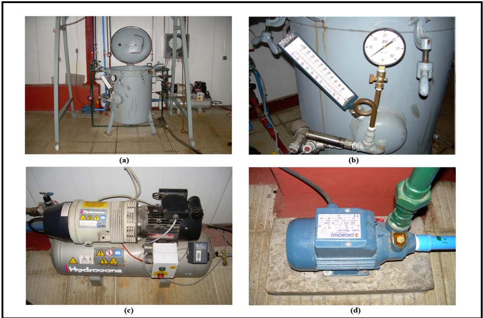
**FIGURA 26. Sistema de esterilización. (a) Autoclave vertical. (b) Sistema de medición de presión y temperatura. (c) Compresor Hydrovane. (d) Bomba centrífuga Pedrollo.**
