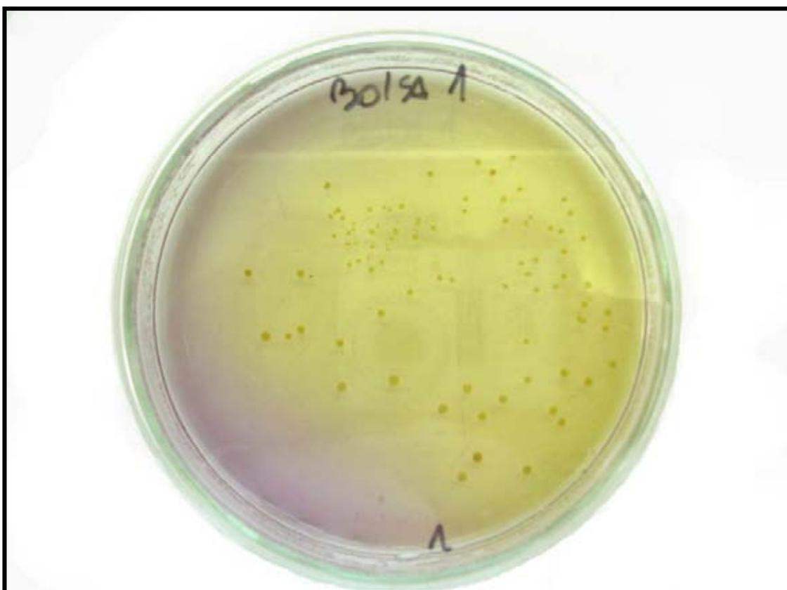
**ANEXO 8.2** UFC de *B. stearothermophilus* obtenidos en la muestra B-6 después del tratamiento térmico.
