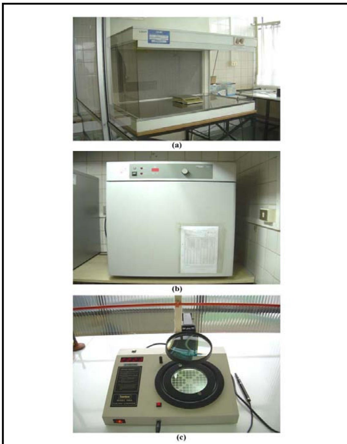
**FIGURA 16.** Equipos laboratorio. (a) Campana de flujo laminar. (b) Incubadora VWR Scientific Products. (c) Contador de colonias Bantex.
