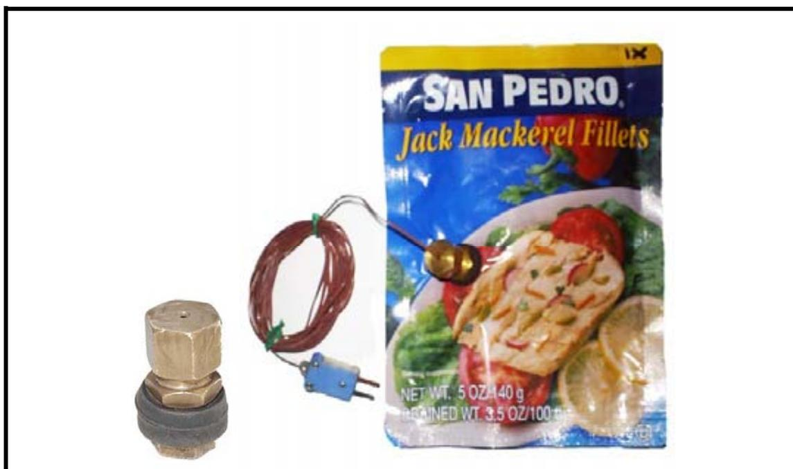
FIGURA 27. Filete de jurel envasado al vacío en bolsa esterilizable con dispositivo de cobre y termocupla.
