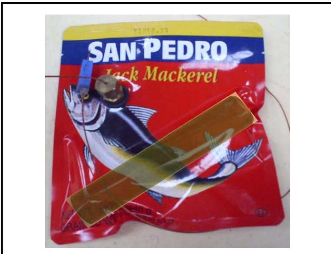
**FIGURA 37. Cilindro de cobre envasado al vacío en bolsa esterilizable.**
