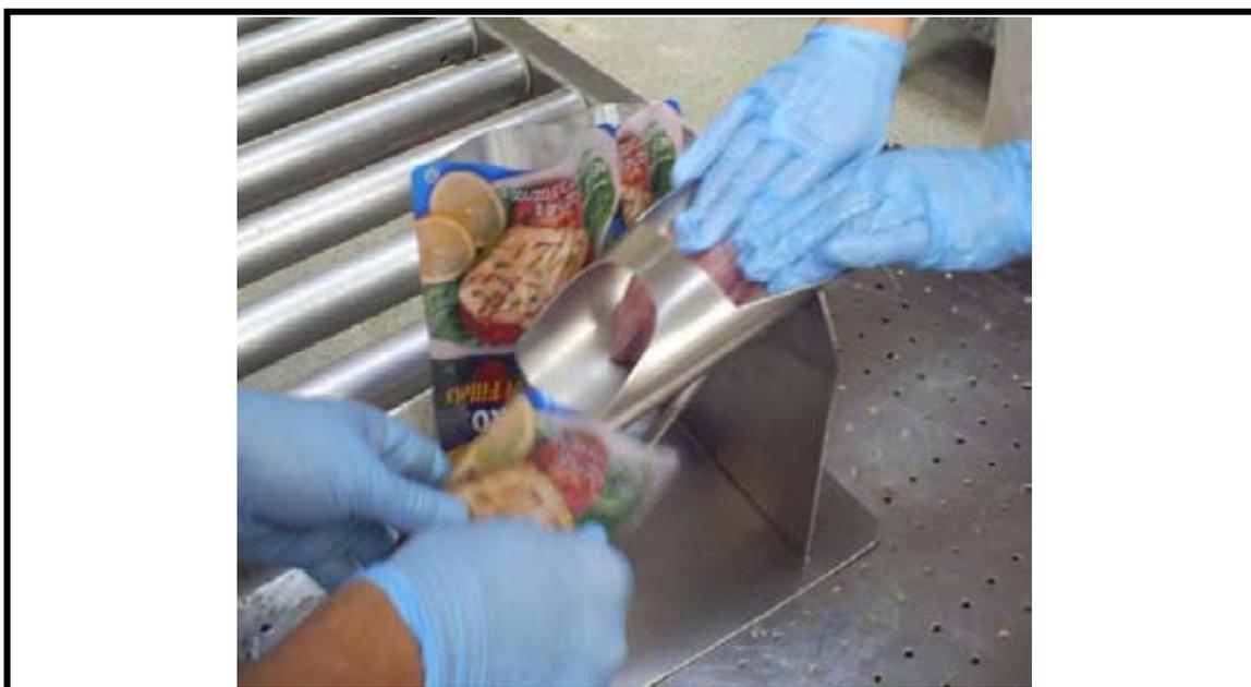
**FIGURA 30. Sistema de llenado para filetes con boquilla dosificadora metálica.**
