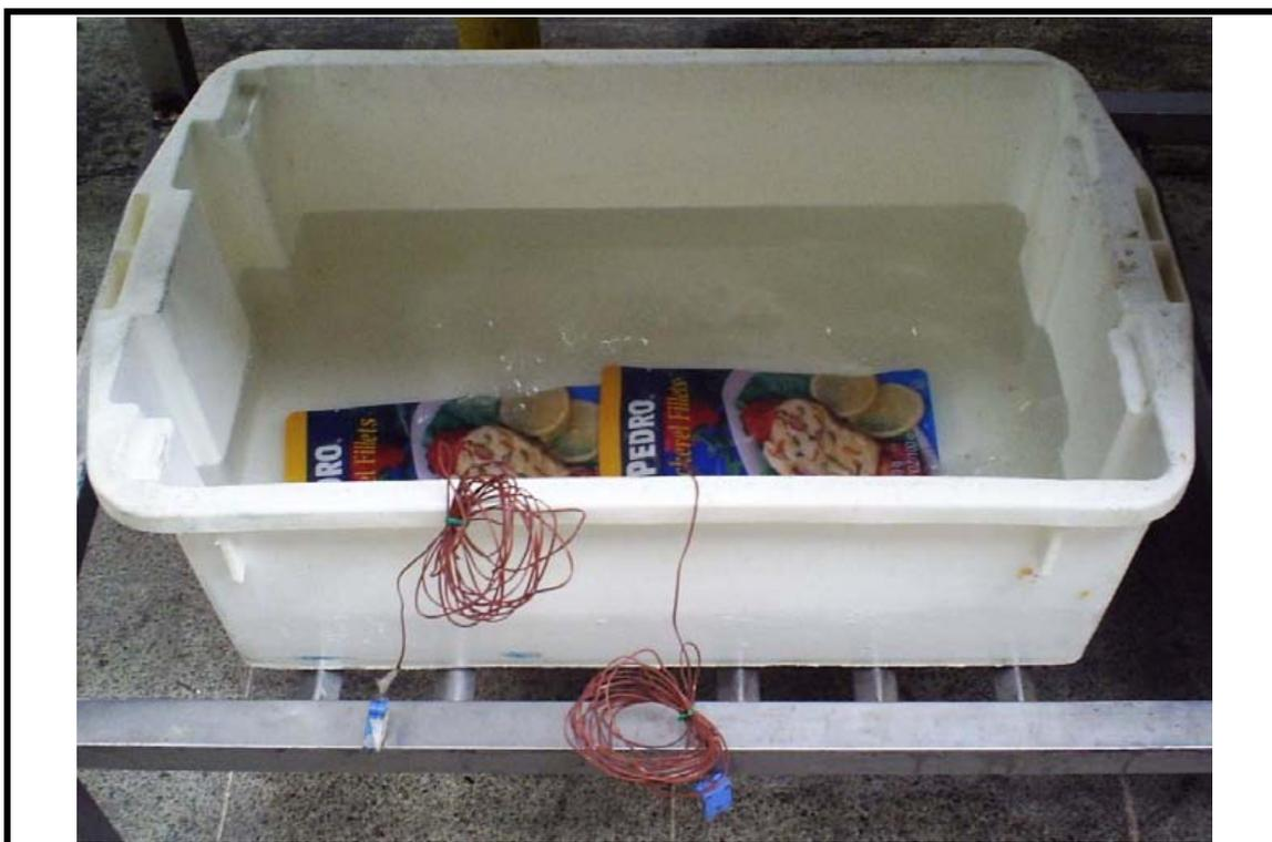
**FIGURA 34. Bolsas selladas y calibradas bajando su temperatura mediante agua con hielo.**
