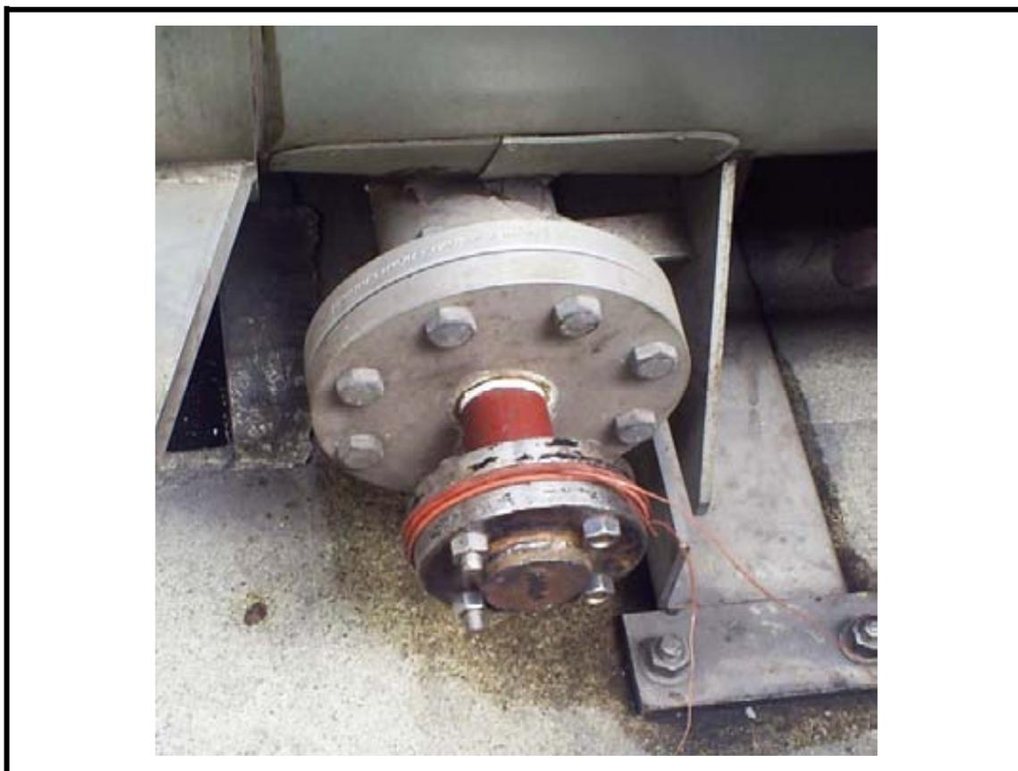
**FIGURA 17. Dispositivo para el ingreso de termocuplas al interior del autoclave.**
