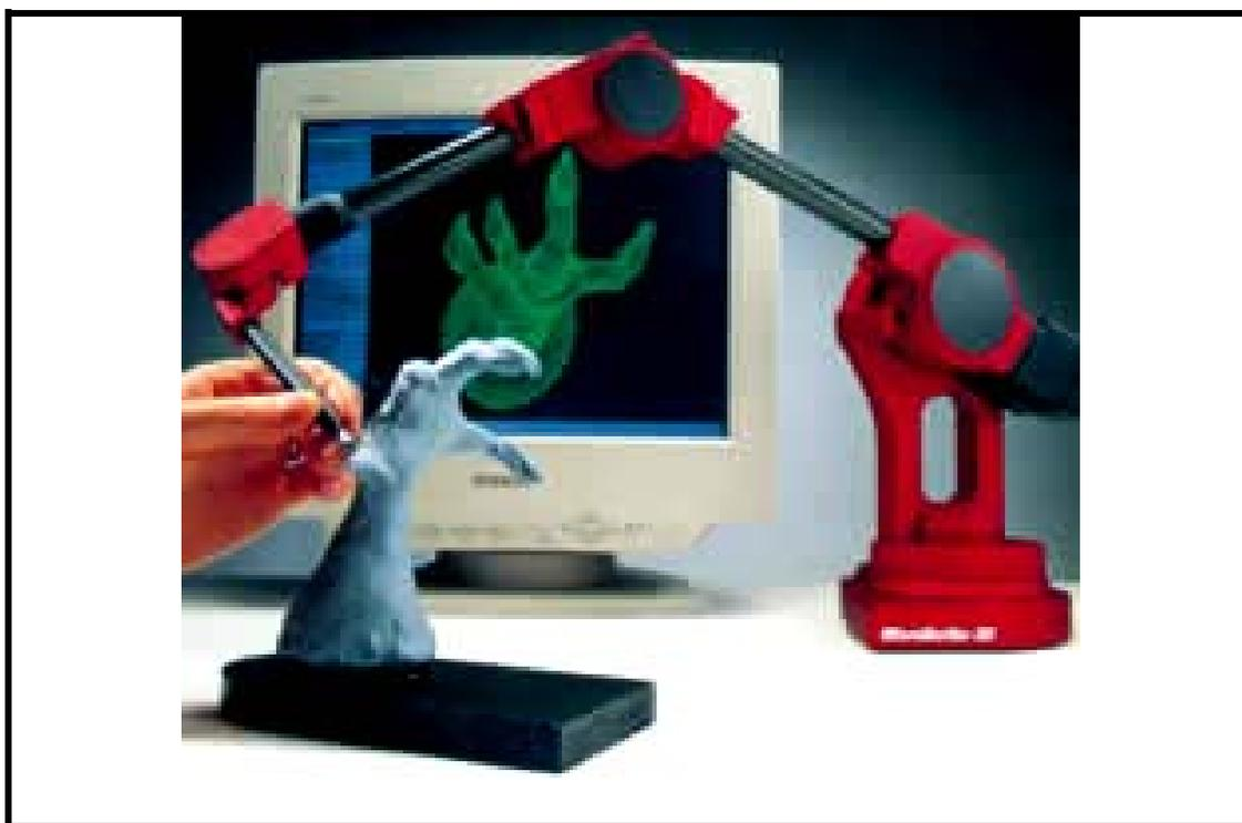
**FIGURA 14.** Captura de puntos y obtención del modelo digital mediante el Brazo digitalizador Microscribe-G2L<sup>TM</sup>.
