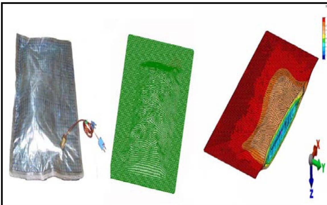
**FIGURA 12** Modelo físico, mallado y diagrama de contorno en ALGOR® de filetes de salmón en bolsas esterilizables.
