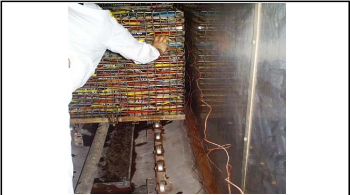
**FIGURA 23.** Ingreso de carros con termocuplas ubicadas para prueba de distribución de temperatura.
