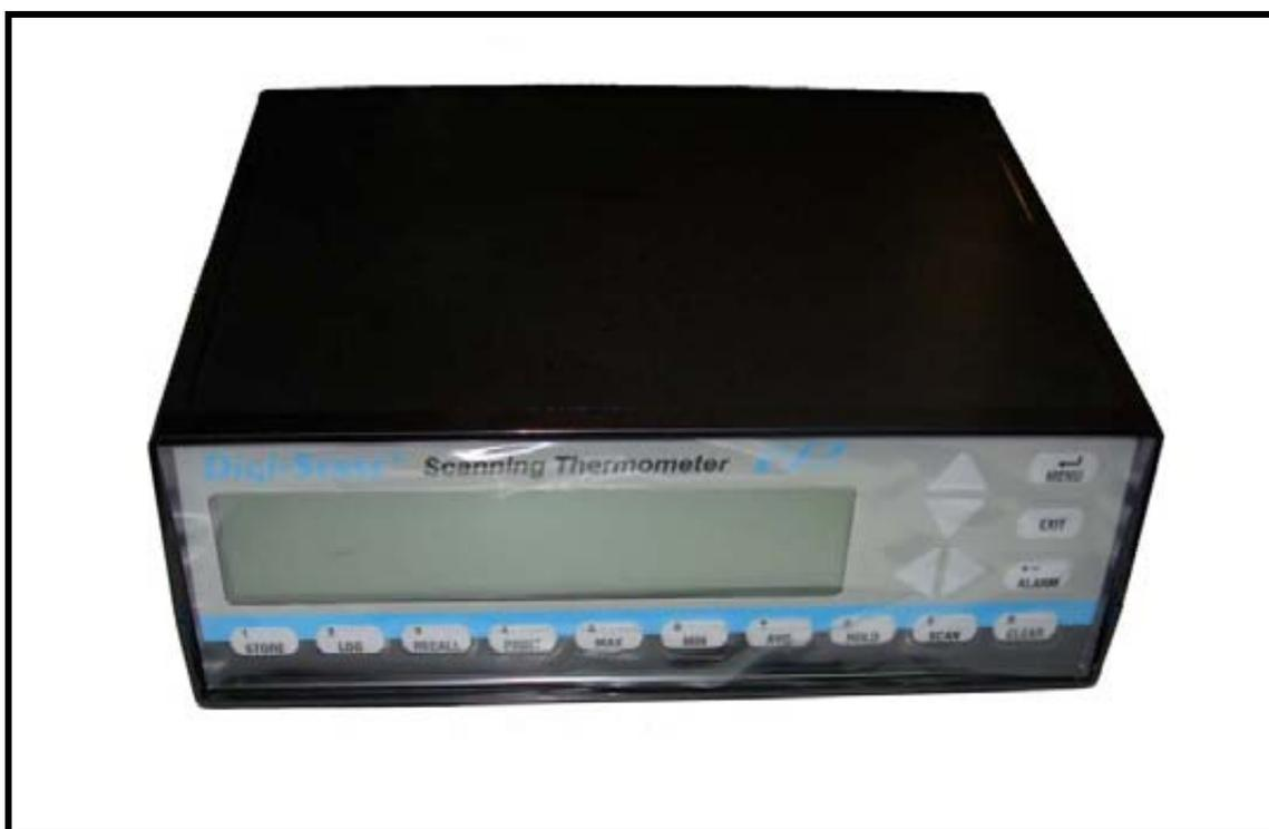
**FIGURA 20. Registrador de Temperaturas (*Data logger*) de 12 canales *Digi-Sense*.**
