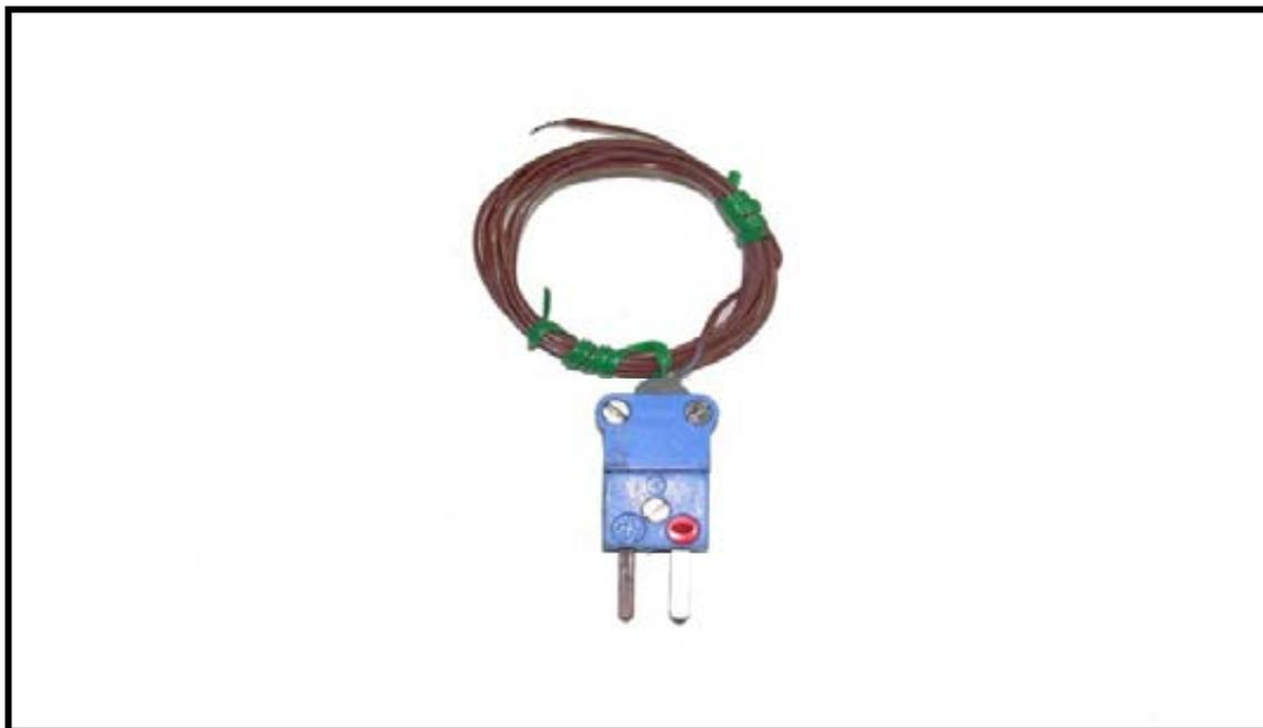
**FIGURA 22. Termocuplas del tipo T (Cobre – Constantán).**
