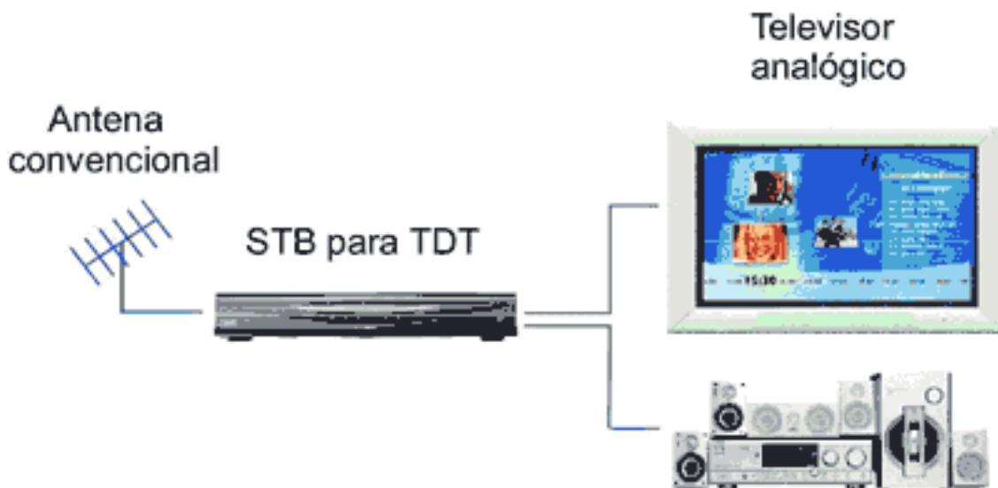
Figura 4. Esquema de conexión de un STB a un televisor analógico.
