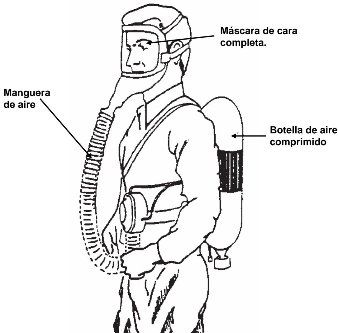
**Figura N°5.21. Equipo de respiración autónomo con botella de aire comprimido sobre la espalda.**
