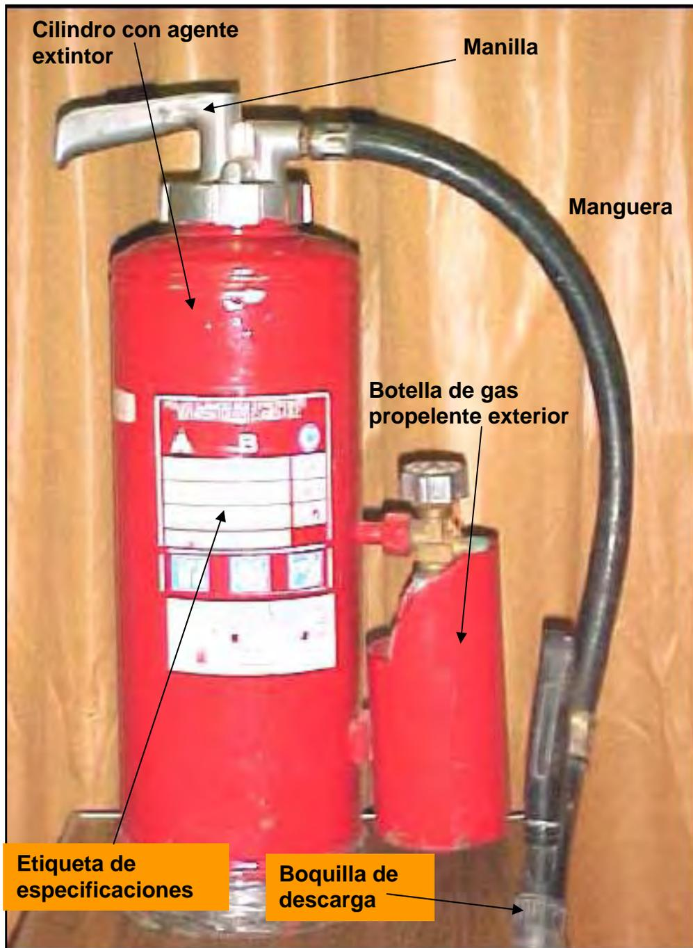
Figura N°5.19. Extintor portátil con gas propelente exterior.
