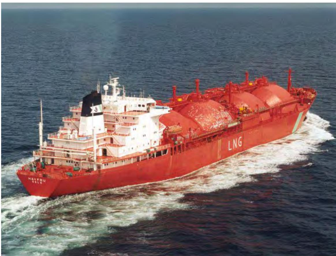
**Figura N°2.20. Buque “Havfru”, único construido con planta de propulsión principal con motor de baja velocidad de dos combustibles.**
