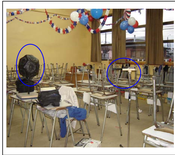
Figura 15: Fuente Omnidireccional y AL1, para la determinación del Tiempo de reverberación.
