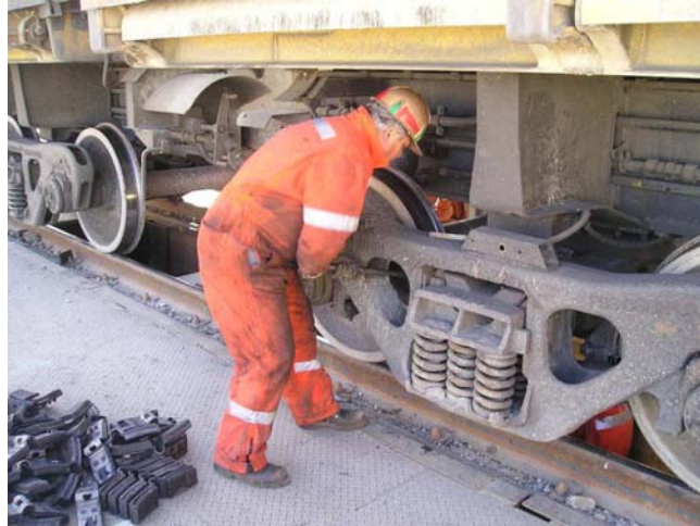
Fig. 5.9. Mantenedores realizando cambio de zapatas en terreno.
