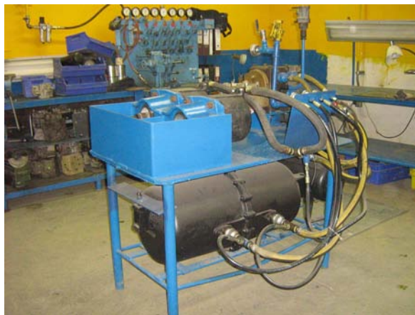
Fig.5.4. Banco de prueba para componentes neumáticos del sistema frenos.
