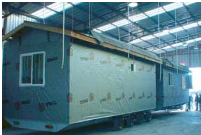
Figura 1 - 1: Modulo tridimensional, producido en fábrica.
