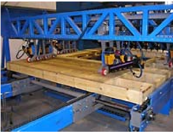
Figura 5 - 1: Fábrica de entramados de madera, puede denominarse “fábrica fija”
