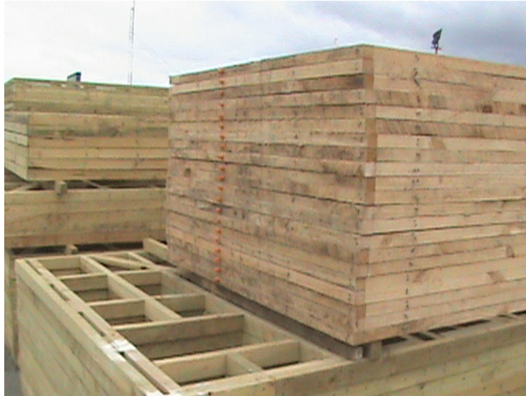
Figura 1 - 2: Módulos panelizados, listos para ser empaquetados y transportados a la obra.
