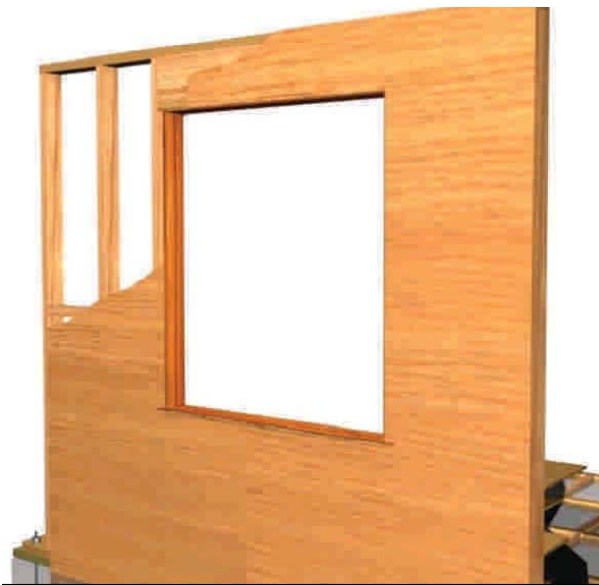
Figura 2 – 3: Elevación exterior de un tabique soportante estructural prefabricado montado sobre su plataforma base
