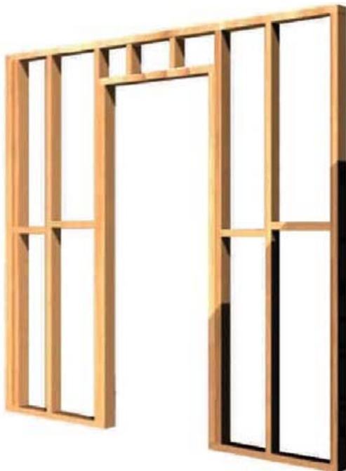
Figura 2 - 2: Elevación de un tabique autosoportante prefabricado.
