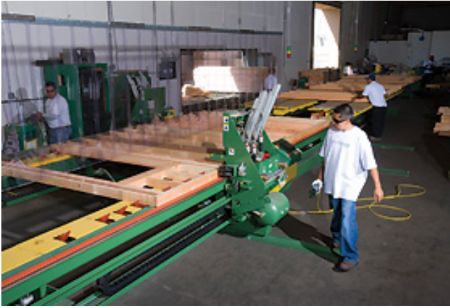
Figura 1 - 2: Industria especializada que muestra la estación en la que se arman los tabiques y se realizan las uniones de los elementos.
