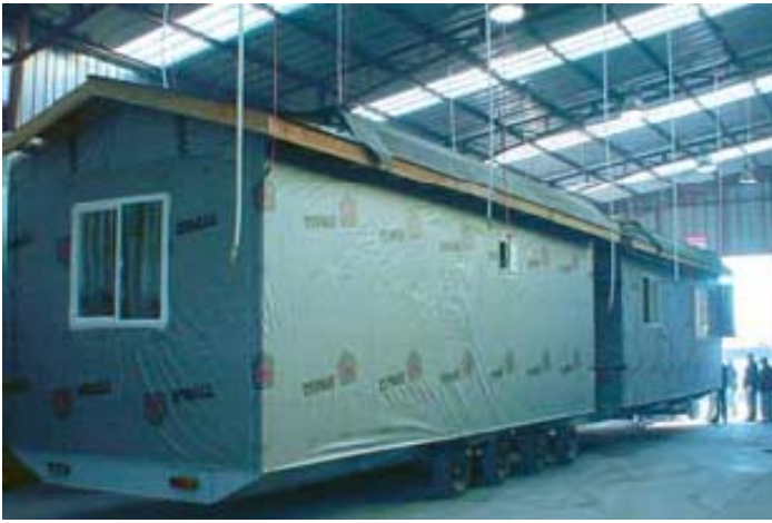
Figura 4 - 29: Modulo tridimensional, listo para ser transportado y montado.
