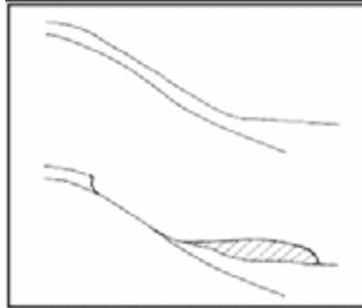
**Figura 2.2.1a** Falla de flujo causada por licuación
