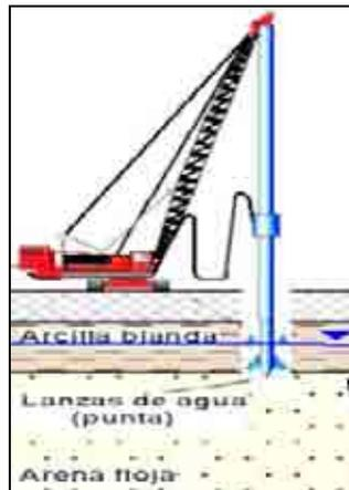
**Figura 4.2.2.1a** Perforación del terreno por chorros de agua.
