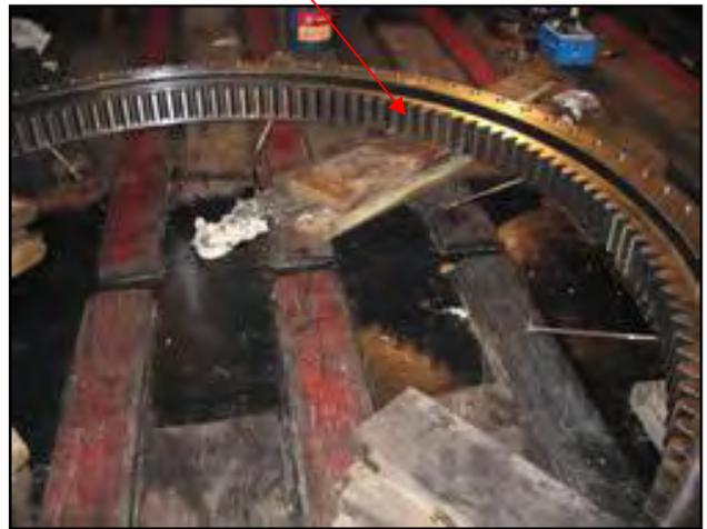
**Figura N° 4.7 Detalles de la sercha dentada.**
