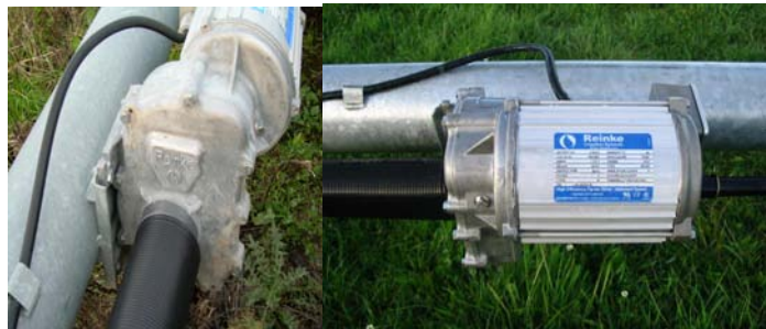
FIGURA N° 24 Reductor de velocidad, motor y eje de propulsión.
