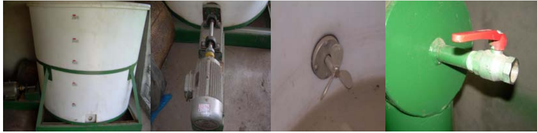
FIGURA N° 11 Estanque fertilizador, motor agitador, hélice agitadora y entrada de fertilizante al sistema. (Este equipo de fertirrigación no se utilizó durante la temporada de riego).
