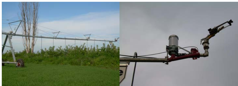
FIGURA N° 30 Voladizo y cañón final.
