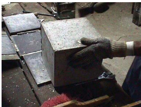
Fotografía N° 4: Desmolde de probetas cúbicas para luego ser pesadas, medidas y ensayadas.
