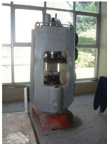
Fotografías N° 5: Ensayo de compresión a una probeta cúbica
