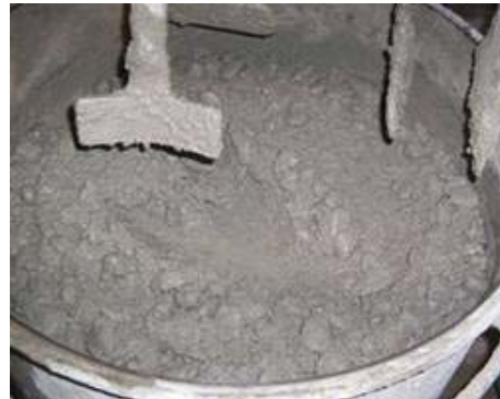
Fotografía N° 3: Mezcla de Hormigón en estado fresco.
