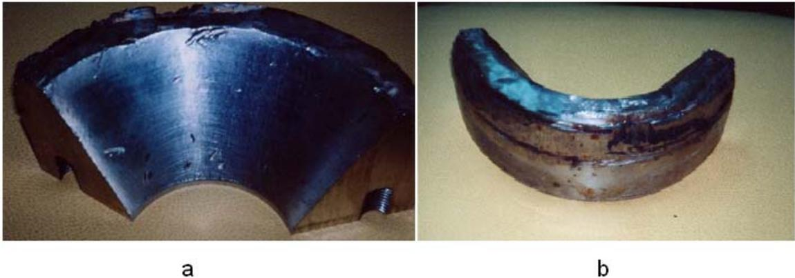
**Fig. 8.7.** Soporte inoxidable desprendido del montaje, (a) Vista de frente, (b) Vista posterior.
