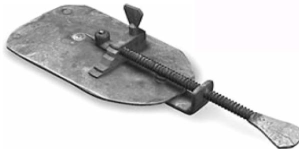
**Fig. 5.1.** Microscopio diseñado por Leeuwenhoek, (FEI Company 2004).
