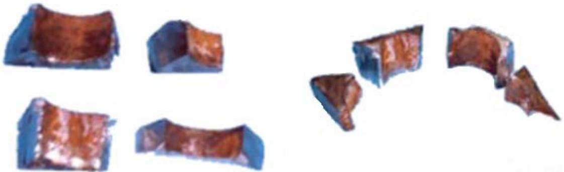
**Fig. 8.1.** Partes de rotor fracturado con fisuramiento superficial.
