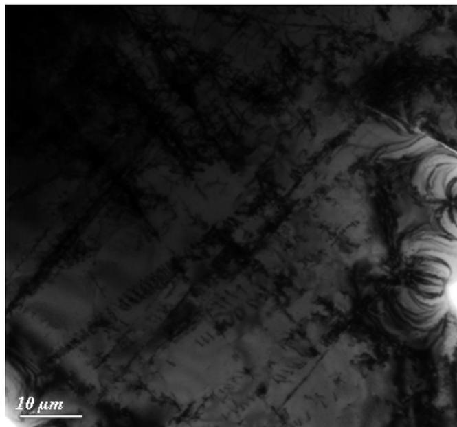
**Fig. 9.12.** Cuña un poco gruesa con presencia de dislocaciones de baja densidad, zona 07
