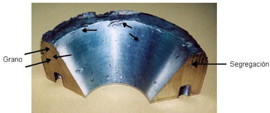
**Fig. 8.8.** Diferencia de granos superficiales e interior en corte.
