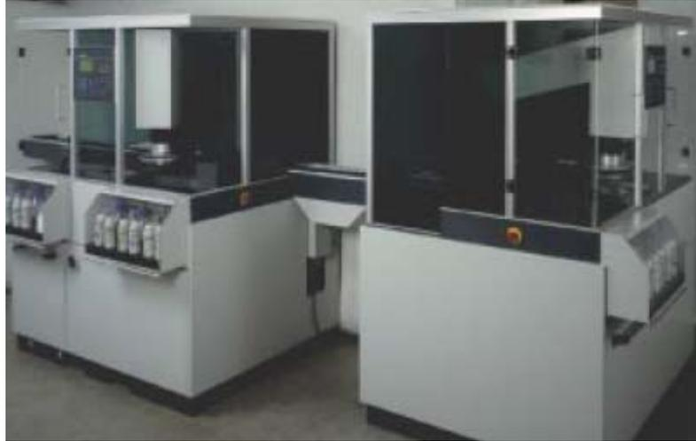
**Fig. 3.10.** Equipos para preparación de muestras totalmente automático de Struers , ([www.struers.com](http://www.struers.com)).
