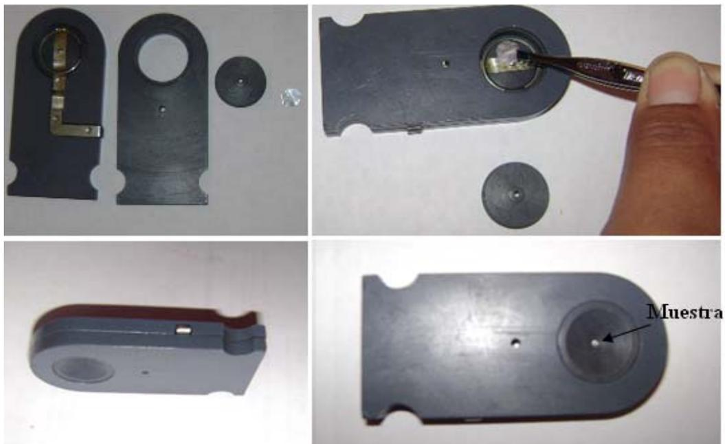
**Fig. 7.6.** Montaje de láminas al porta muestras.
