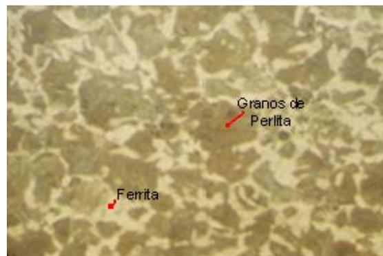
**Fig. 2.12.** Microfotografía de acero al carbono SAE 1045.
