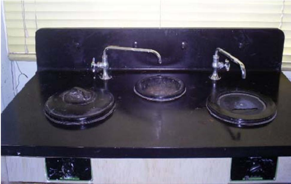
**Fig. 3.4.** Lijadora y pulidora semiautomática Buehler, perteneciente al IMPT.
