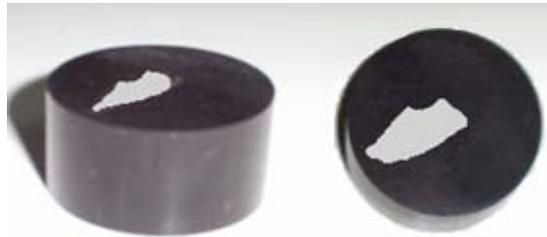
**Fig. 3.3.** Muestra en baquelita, mediante montaje en caliente.
