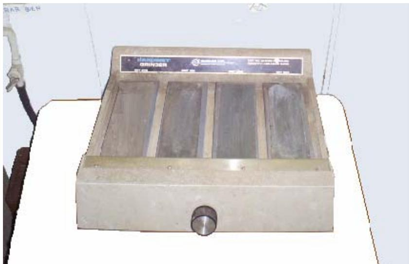
**Fig. 3.5.** Lijadora y pulidora manual Handimet Grinder Buehler, perteneciente al IMPT.
