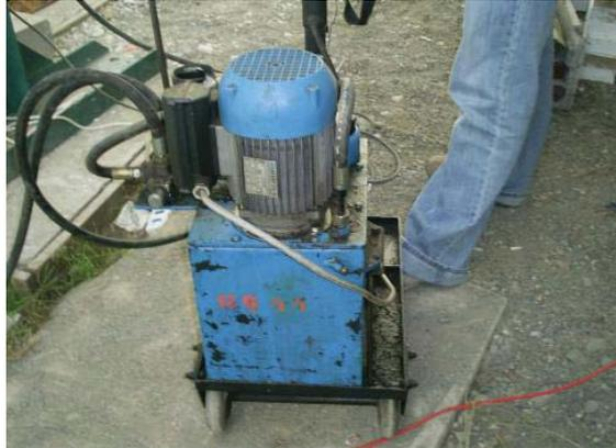
*Figura 4.4. Bomba hidráulica.*
