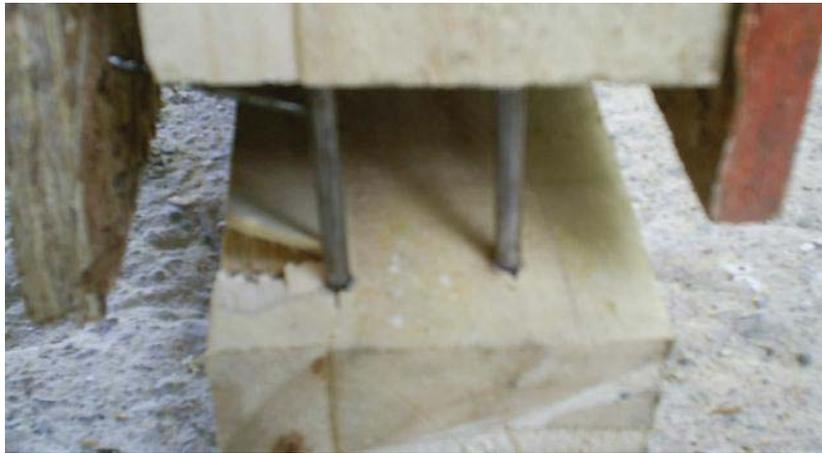
*Figura 4.8. Deformación obtenida en la parte inferior del tabique luego de ser aplicada la última carga. (Vista frontal del tabique).*
