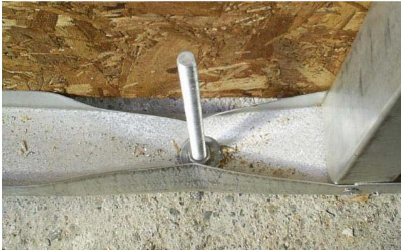
*Figura 5.1. Deformación obtenida en la solera inferior del tabique luego de ser aplicada la última carga.*
