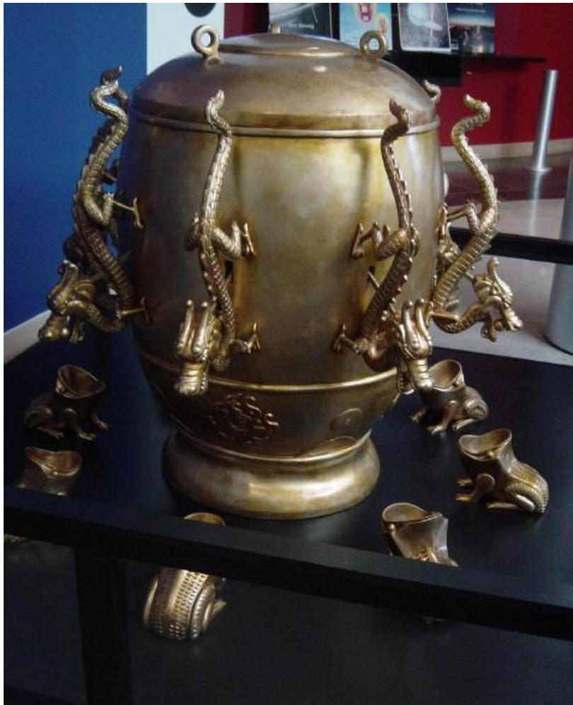
**Fig. Nº 3 Sismografo de Zhang Heng. Construido en china el año 130dc. Es considerado el primer instrumento de detección de vibraciones moderno.**
