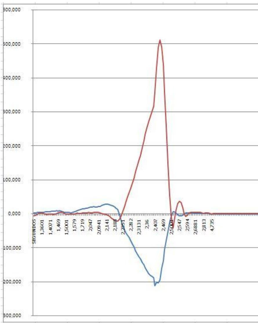
Figura N°50: Grafico de aceleración de los datos utilizado para la evaluación del periodo propio y el grado de amortiguamiento del acelerómetro.
