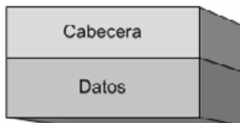
*Figura 2- Datagrama IP básico, Compuesto por cabecera y datos.*
