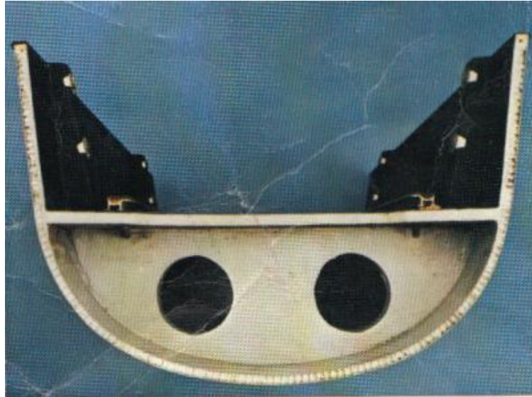
Figura 2: Sección transversal canoa de alto rendimiento con núcleo honeycomb.
