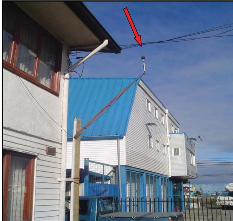
**Figura 4:** Estación fija ubicada a 7.5 m del suelo, micrófono.
