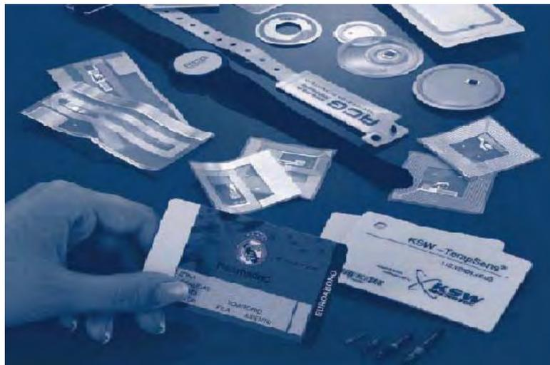
**Figura 7.5** Diversas tarjetas, pulseras y otro tipo de dispositivos RFID
