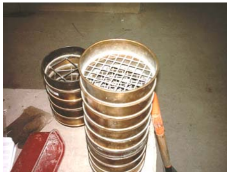
Fig. N° 6. Serie de tamices utilizados en granulometría de gravas. Fuente: Elaboración propia.
