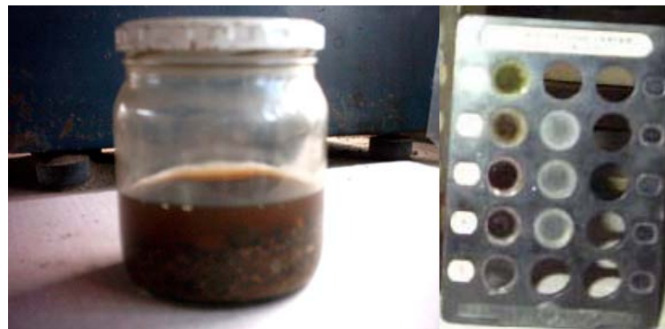
Fig. N° 5. Ensayo colorimetría NCh 166 of 52. Fuente: Elaboración propia.
