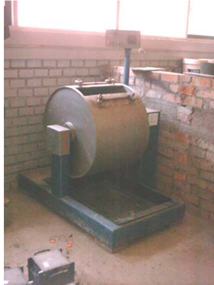
Fig. N° 7. Máquina de Los Angeles. Ensayo NCh 1369.0f78 Determinación del desgaste de las gravas.
