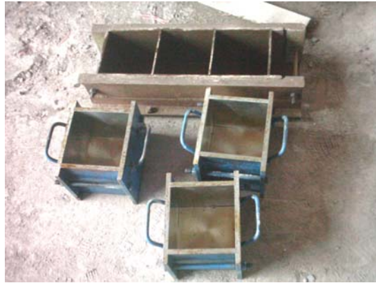
Fig. N° 10. Moldes cúbicos de 150 mm. Fuente: Elaboración propia.
