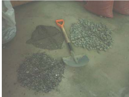
Fig. N° 4 Cuarteo a pala. Fuente: Elaboración propia.
