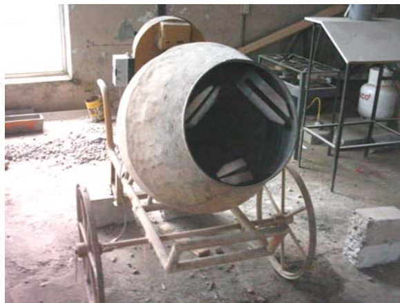
Fig. N° 8. Betonera donde se fabrico el hormigón. Fuente: Elaboración propia.
