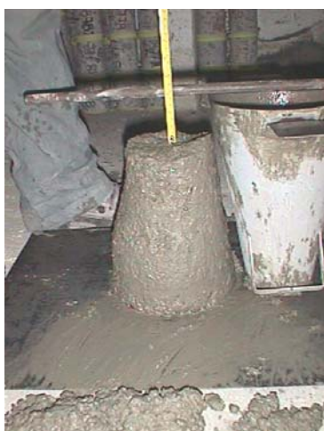
Fig. N° 9. Asentamiento de cono de Abrams. Fuente: Elaboración propia.
